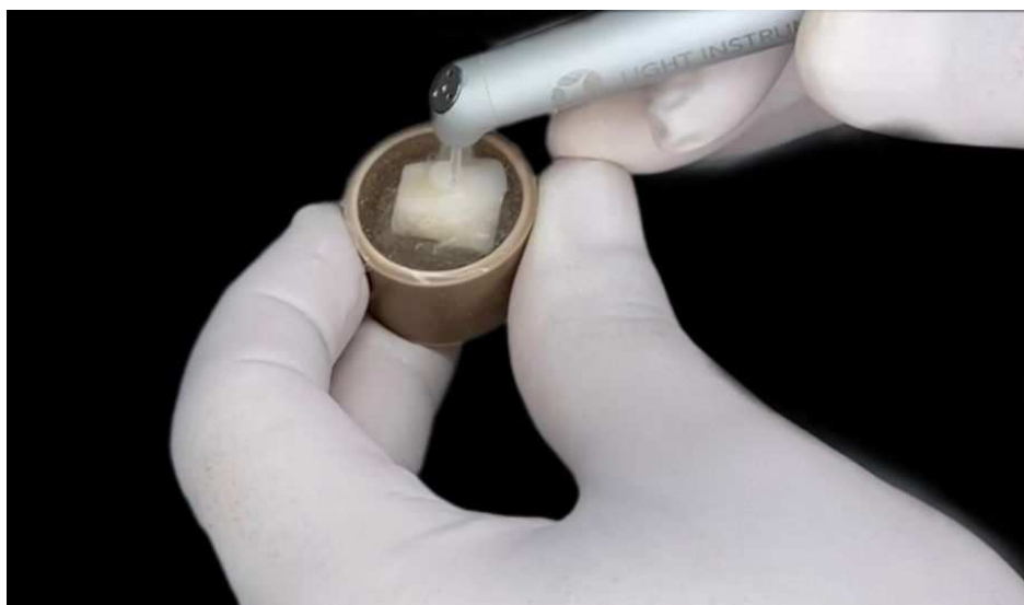
Figura 14 – Aplicação do laser Er: YAG sobre a amostra de cerâmica
