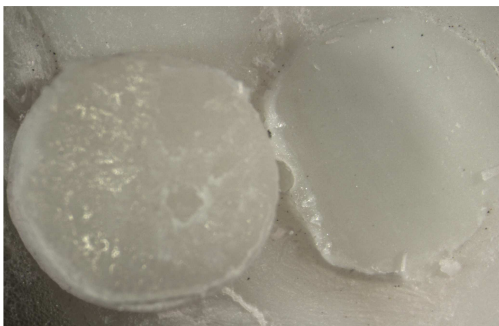
Figura 16 – Análise em estereomicroscópio da classificação de modo de falha do tipo A
