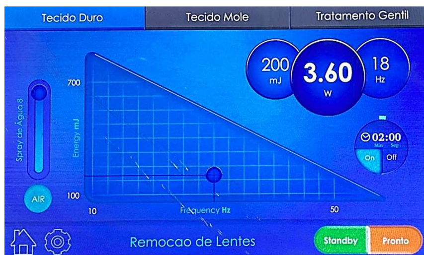
Figura 13 – Parâmetros de potência do laser Er: YAG
