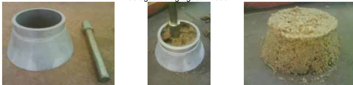
Figura 10- Fotografia do tronco de cone e soquete metálico para a realização do ensaio de absorção de água do agregado miúdo.
