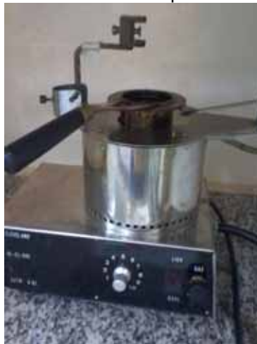
Figura 1- Fotografia do aparelho de Cleveland para determinação do ponto de fulgor.
