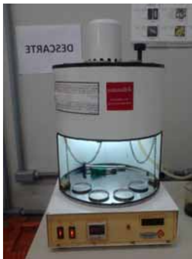
Figura 5- Aparato experimental para determinação da viscosidade de Saybolt dos ROC e ROL.
