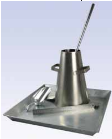
Figura 14- Fotografia do tronco de cone para ensaio de abatimento.
