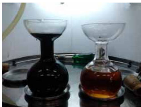
Figura 8- Fotografia do recipiente contendo ROL (à esquerda) e ROC (à direita) para a realização do teste de viscosidade de Saybolt Furol.
