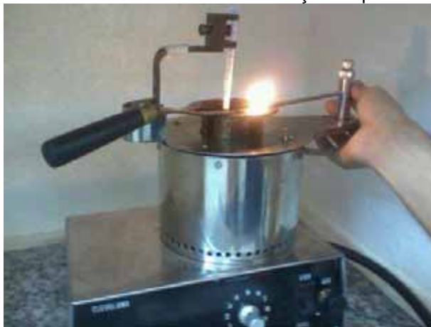
Figura 3- Fotografia do teste de chama na determinação do ponto de fulgor da amostra
