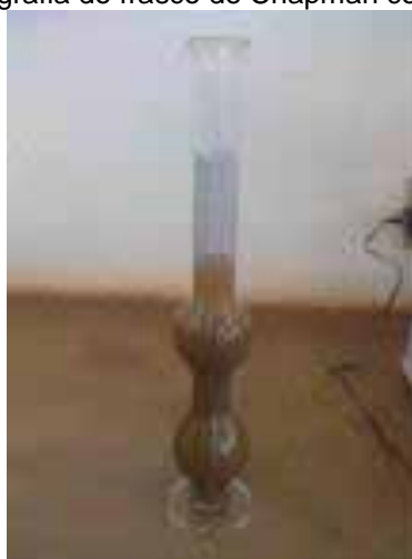
Figura 9- Fotografia do frasco de Chapman com areia e água.
