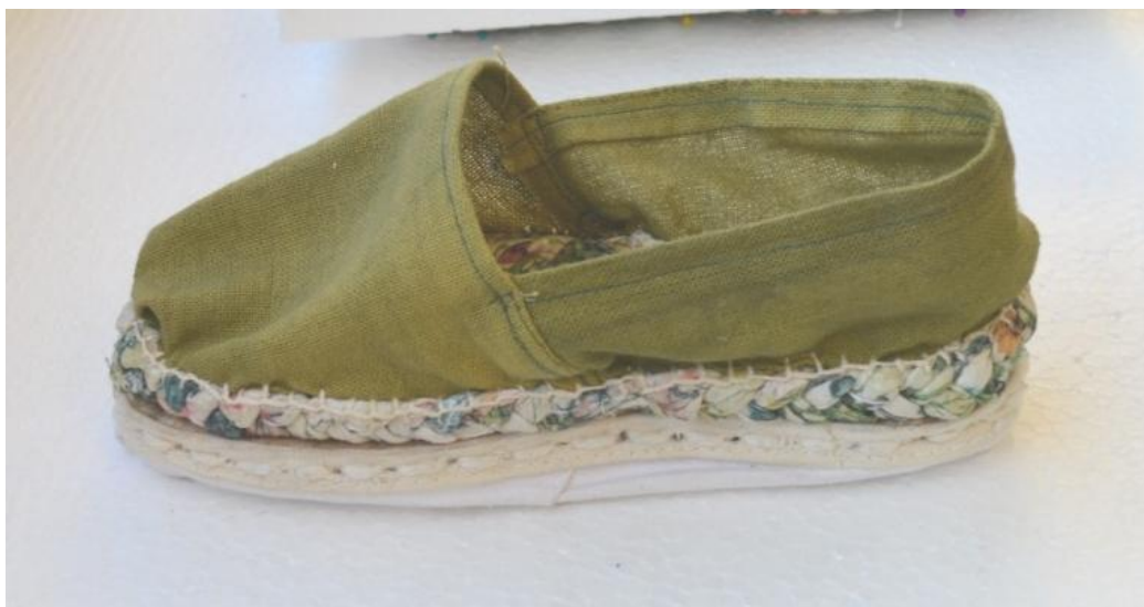
Figura 4.28: Verificação visual do formato do solado. Sapato produzido colocado em sobreposição à Alpargata de Rueda.
