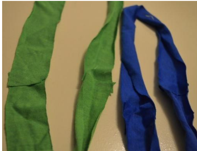
Figura 4.20: Tiras de malhas cortadas e unidas com cola.
