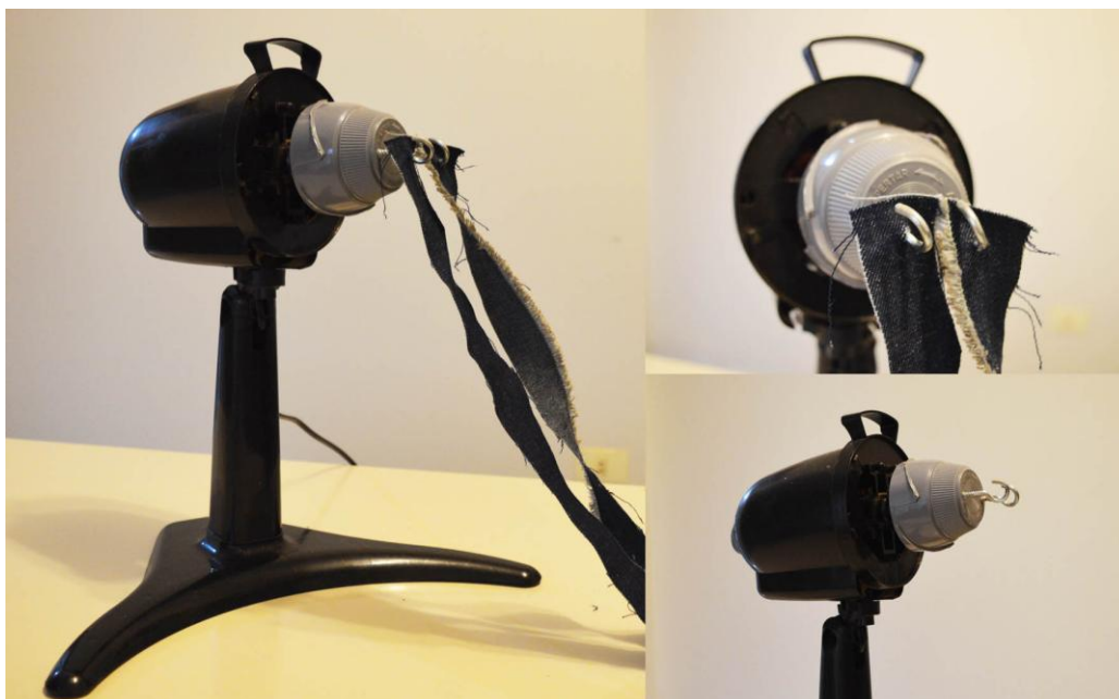
Figura 4.9: Ventilador adaptado para fazer as cordas e detalhes da fixação das tiras nos ganchos.
