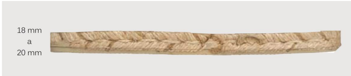
Figura 2.27: Altura da trança para fazer o solado.
