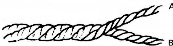
Figura 4.8: Fios retorcidos por dois cabos.
