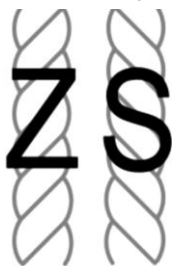
Figura 4.7: Torção S e Z.
