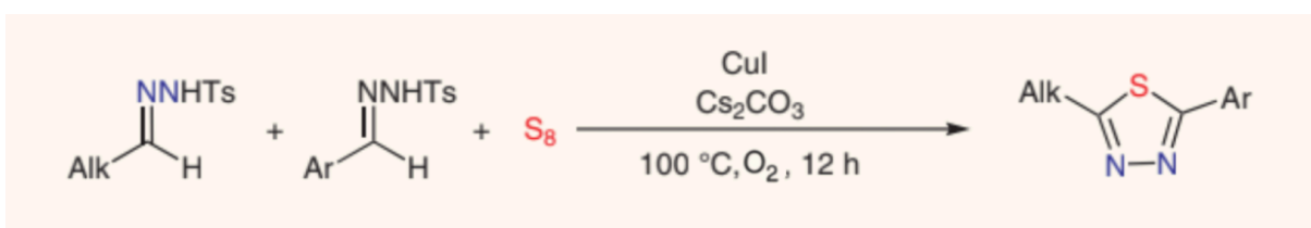
Figura 3 - Esquema geral da síntese de 1,3,4-tiadiazóis 2,5-dissubstituídos catalisada por cobre em presença de base e enxofre elementar.
