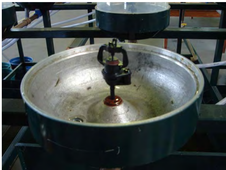
Figura 5. Microaspersor colocado na câmpula para teste de variaçãõ de fabricaçãõ.
