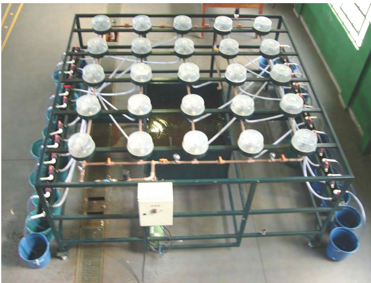
Figura 6. Foto da bancada realizando ensaio com microaspersor azul.
