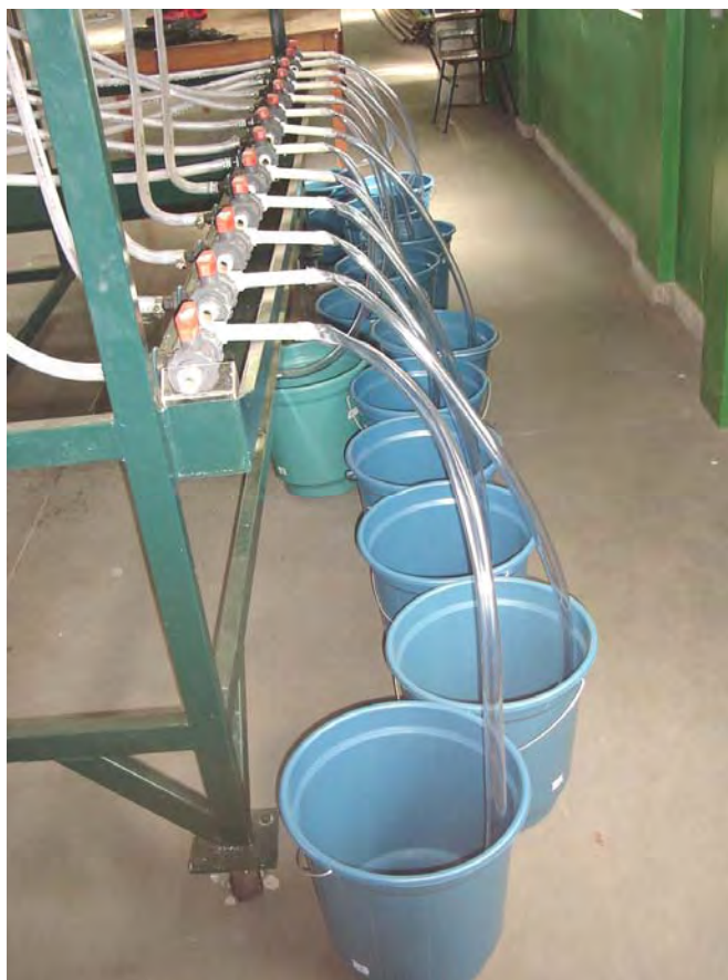
Figura 10. Sistema de coleta da bancada de microaspersores .
