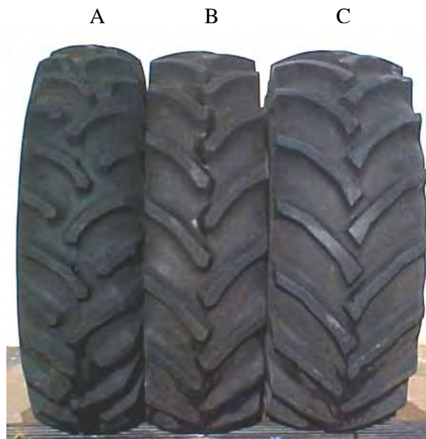
Figura 5. Ilustração frontal dos pneus Diagonal (A), Radial (B) e BPAF (C).
