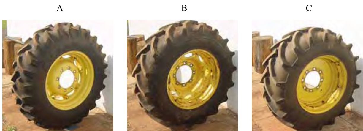
Figura 6. Ilustração lateral dos pneus Diagonal (A), Radial (B) e BPAF (C).
