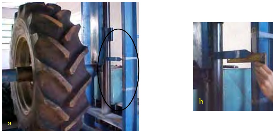
Figura 27. Escala graduada acoplada na prensa (a) e leitura da deformação do pneu (b).
