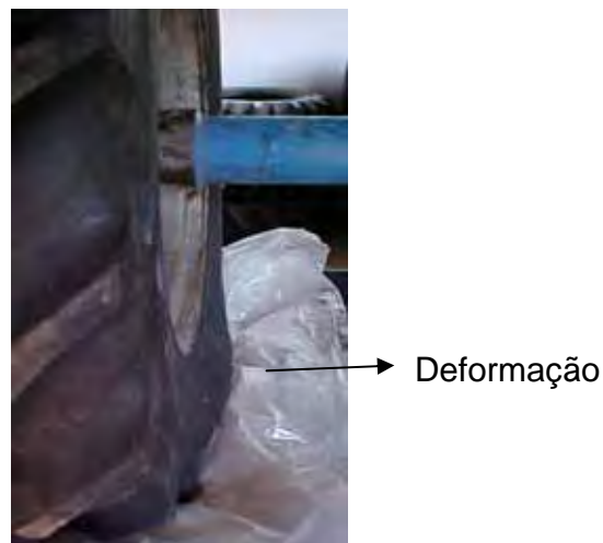
Figura 28. Detalhe da deformação elástica sofrida pelo pneu agrícola.
