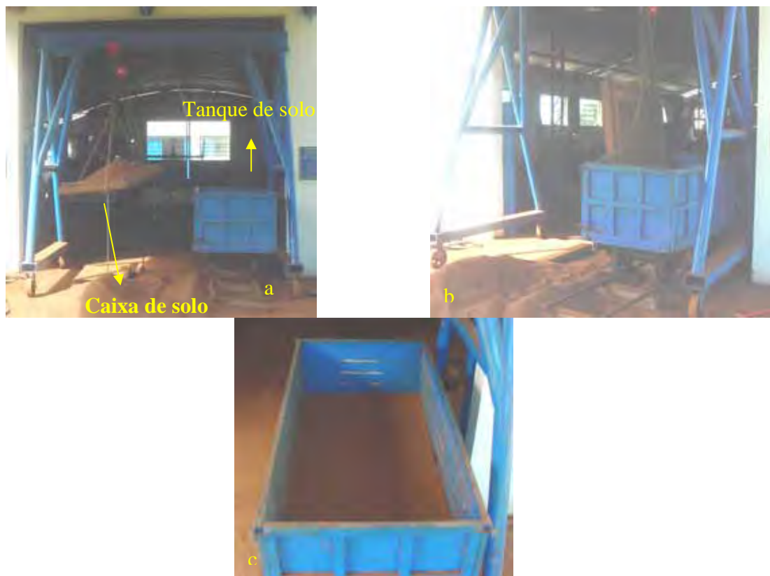
Figura 17. Quadro suspenso pelo pórtico (a), preenchimento do tanque (b) e camada de solo dentro do tanque (c).
