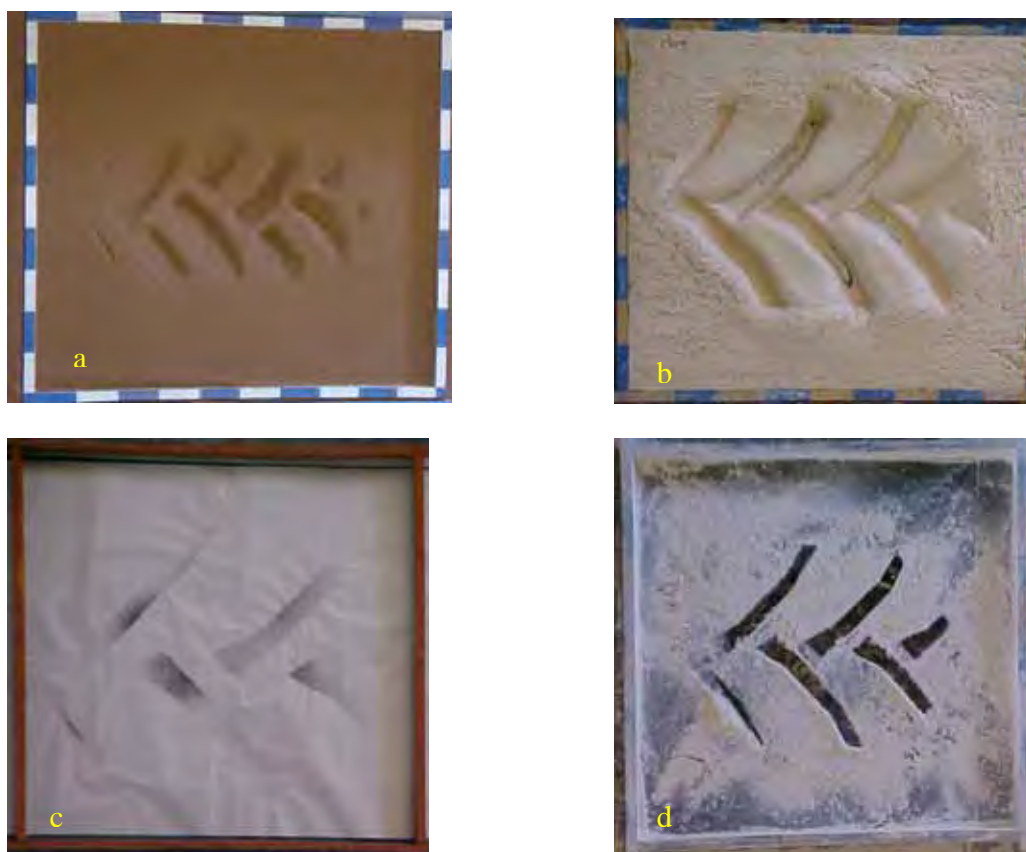
Figura 23. Áreas de contato obtidas em superfície deformável (a) e rígida (massa – b; papel carbono – c; pó – d).
