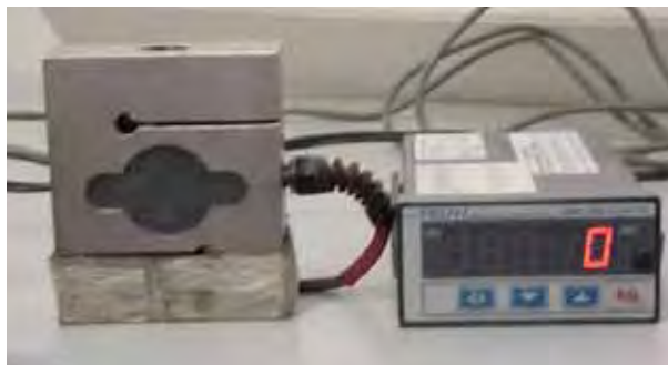
Figura 10. Célula de carga e indicador digital.
