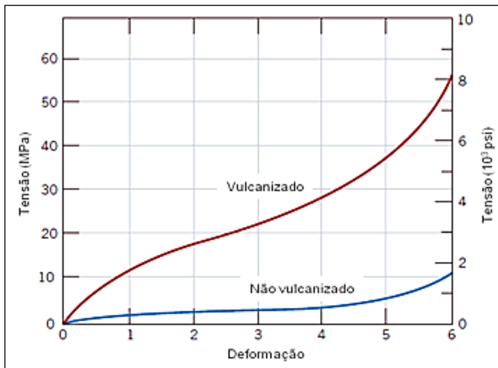
Figura 4 - Curva de tensão x deformação para BN vulcanizado e não vulcanizado a uma deformação de 600%.
