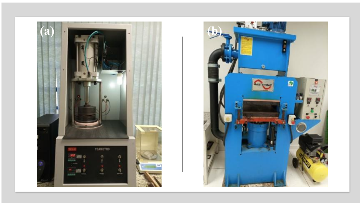
Figura 9 - (a) reômetro da marca Teâmetro e (b) termoprensa hidráulica da marca MasterMac.
