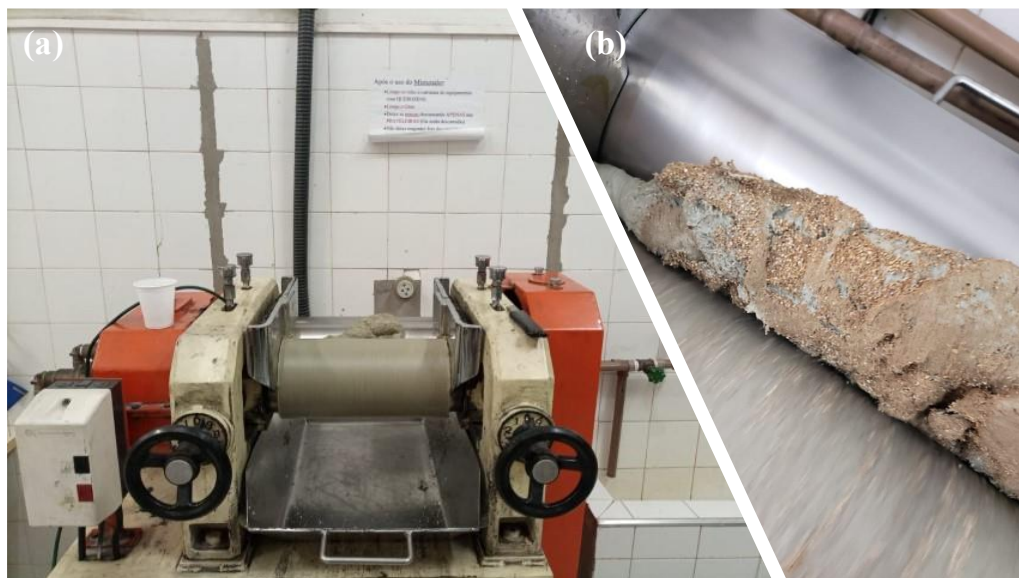
Figura 8 - (a) misturador aberto de rolos da marca Makintec e (b) incorporação dos reagentes no misturador.
