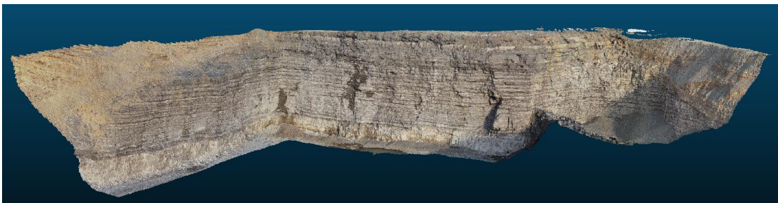
Figura 13- Nuvem densa do talude do setor B no software CloudCompare.
