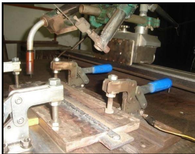
Figura 4.4 - Detalhe do sistema do equipamento de translação e da tocha utilizados.
