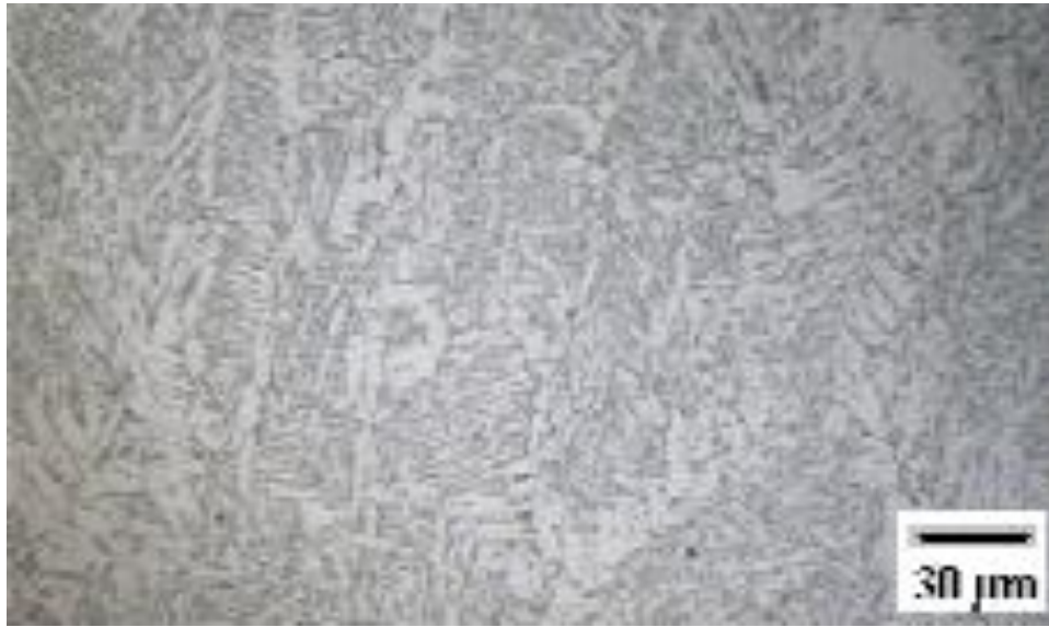
Figura 5.33 - Solda S-1 - Segundo cordão, ( I_p = 435 A, t_p = 2,1 ms, T = 29 °C).
