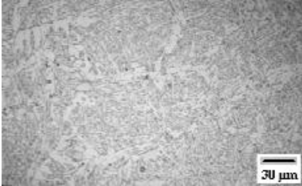
Figura 5.11 - Solda S-2 – primeiro cordão, ( I_p = 435 A, t_p = 2,1 ms, T = 100 °C).
