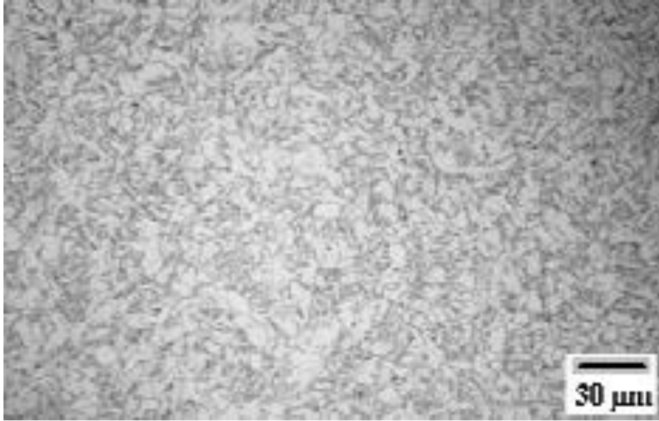
Figura 5.13 - Solda S-2 - Zona recristalizada, ( I_p = 435 A, t_p = 2,1 ms, T = 100 °C).
