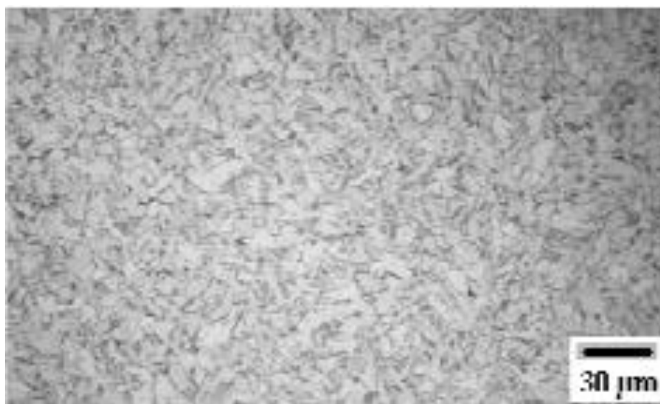
Figura 5.16 - Solda S-4 - Zona recristalizada, ( I_p = 470 A, t_p = 2,1 ms, T = 100 °C).
