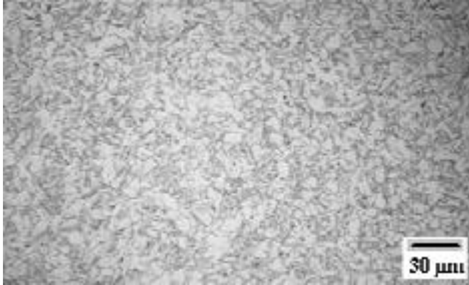
Figura 5.35 - Solda S-2 - Primeiro cordão, ( I_p = 435 A, t_p = 2,1 ms, T = 100 °C).
