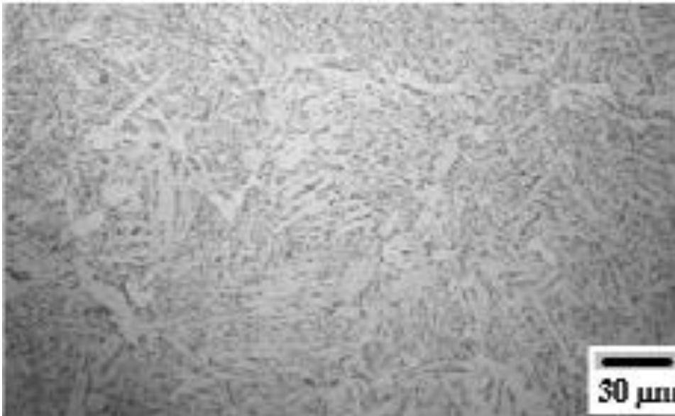
Figura 5.14 - Solda S-4 - Primeiro cordão, ( I_p = 470 A, t_p = 2,1 ms, T = 100 °C).
