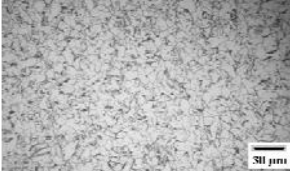
Figura 5.25 - Solda S-7 - Zona recristalizada, ( I_p = 435 A, t_p = 1,9 ms, T = 100 °C).
