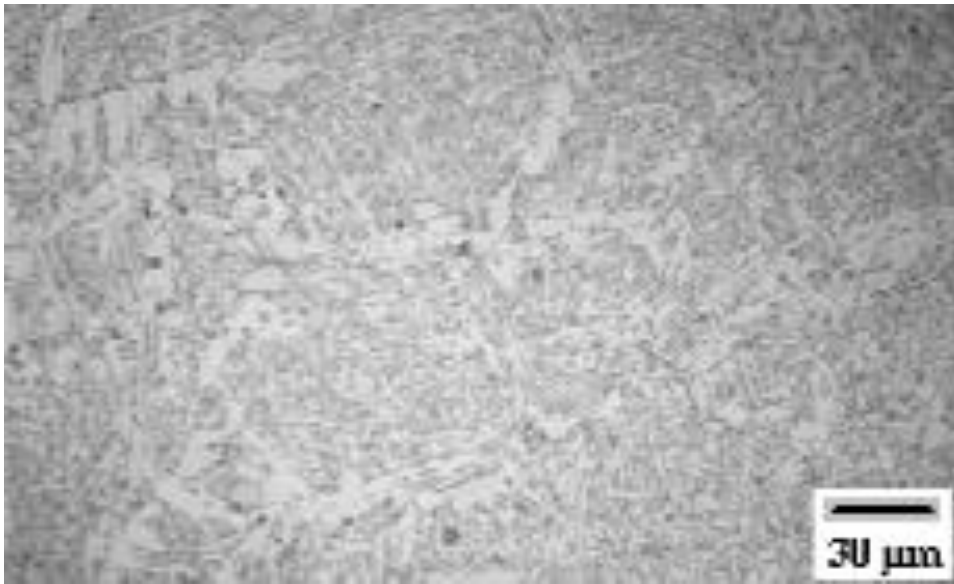
Figura 5.26 - Solda S-2 - Primeiro cordão, ( I_p = 435 A, t_p = 2,1 ms, T = 100 °C).
