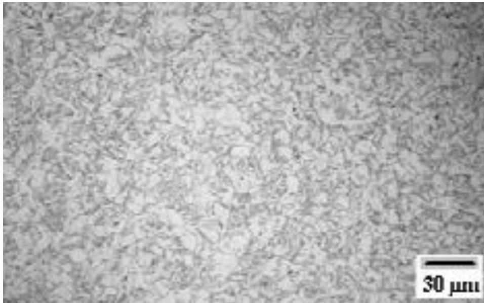
Figura 5.28 - Solda S-2 - Zona recristalizada, ( I_p = 435 A, t_p = 2,1 ms, T = 100 °C).
