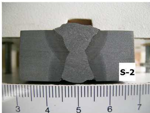
Figura 5.6 - Solda (S-2) condições: I_p = 435 A, t_p = 2,1 ms, T = 100 °C.
