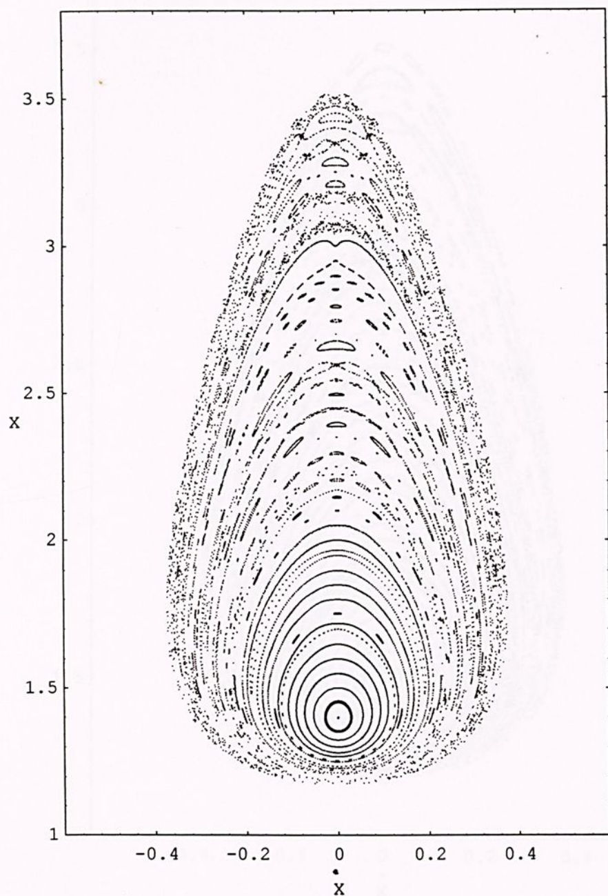
Figura 4.19 - Superfície de seção de Poincaré para o valor da constante de Jacobi 3,080 e razão das massas da ordem de 10^{-5} .
