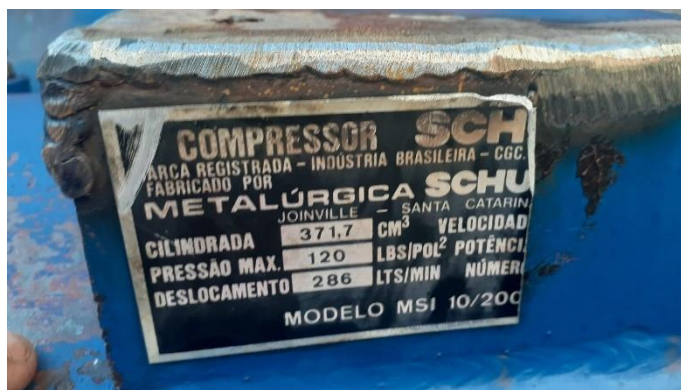
Figura 19 - Placa de identificação do compressor
