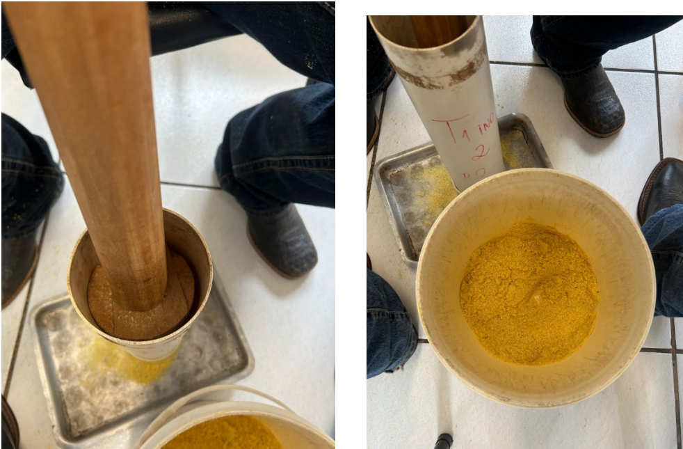
Figura 3 - Compactação da silagem no cano PVC
