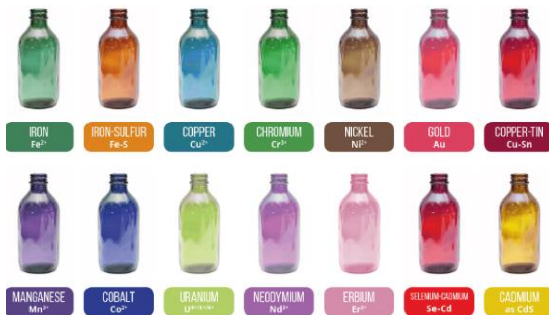
Figura 13 - Coloração dos vidros de acordo com sua composição.
