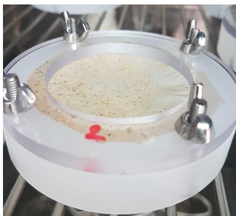
Figura 12: Placa com filme incorporado com camu-camu, colocada em estufa com a temperatura controlada de 25 ± 2 °C e 50 ± 3 % de umidade.
