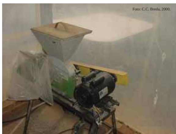
Figura 8: Picadora de forragem TRAPP-TRF100, adaptada pelo CEMEQ/UNESP para a moagem do lodo.
