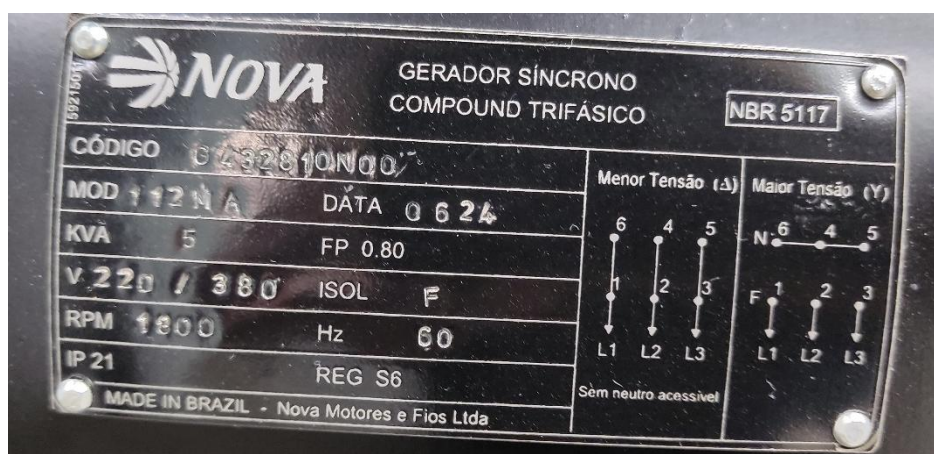
Figura 11 – Dados de placa do gerador
