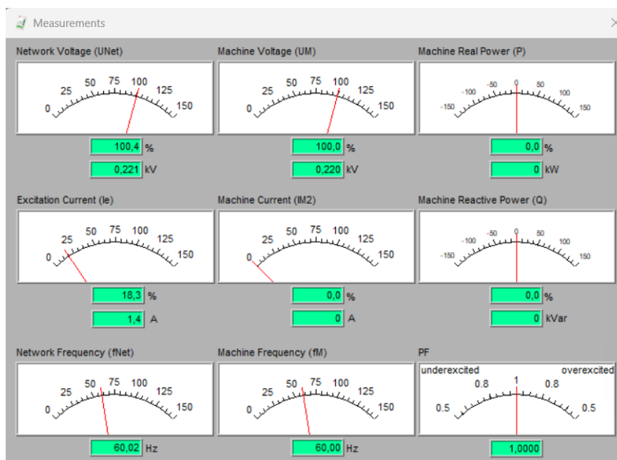
Figura 21 - Medições AVR máquina a vazio
