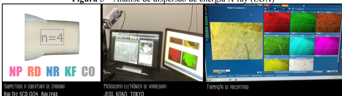
Figura 5 – Análise de dispersão de energia X-ray (EDX)
