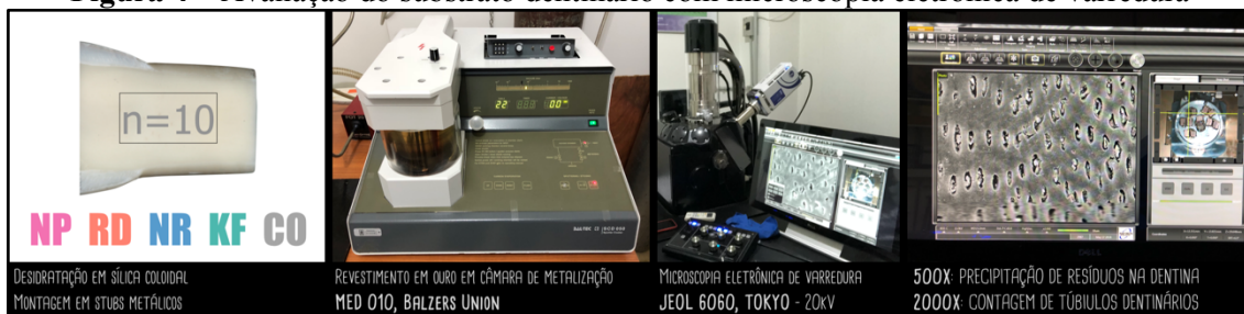
Figura 4 – Avaliação do substrato dentinário com microscopia eletrônica de varredura
