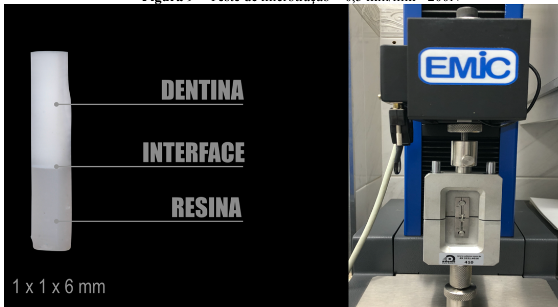
Figura 9 – Teste de microtração – 0,5 mm/min - 200N
