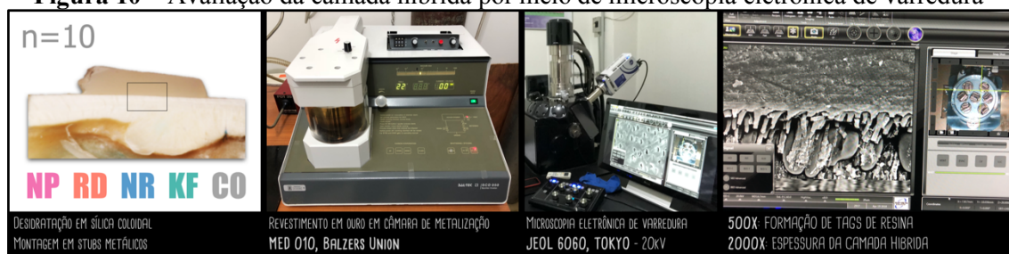
Figura 10 – Avaliação da camada híbrida por meio de microscopia eletrônica de varredura
