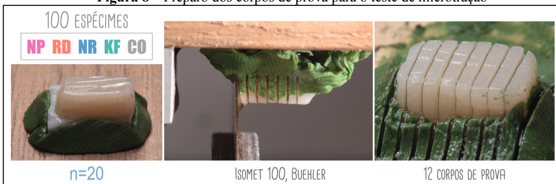
Figura 8 – Preparo dos corpos de prova para o teste de microtração
