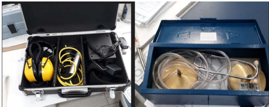
Figura 39 - Geofone digital (esquerda) e mecânico (direita) utilizados pela SABESP de Fernandópolis
