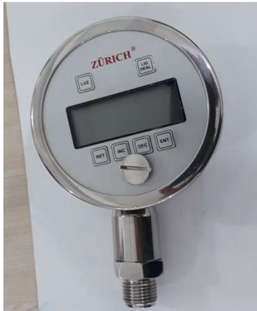
Figura 40 - Manômetro Digital Zürich® utilizado para medição e controle de pressão nas redes de distribuição do município de Fernandópolis
