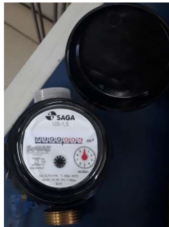
Figura 24 - Micromedidor do tipo velocimétrico utilizado pelo SeMAE
