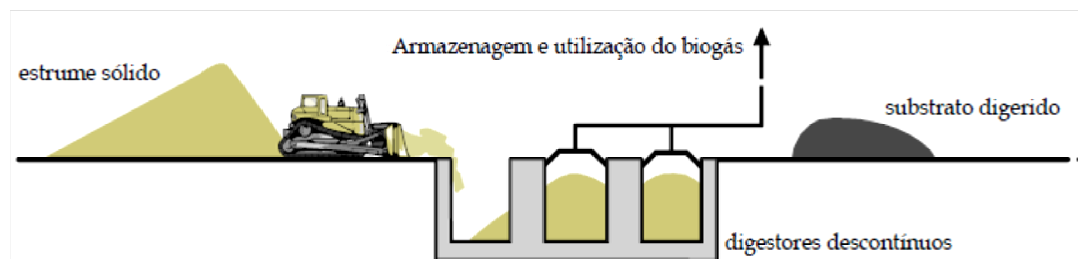
FIGURA 2.3– Sistema descontínuo (batelada) de produção de biogás. Fonte: SALOMOM & FILHO (2007)
