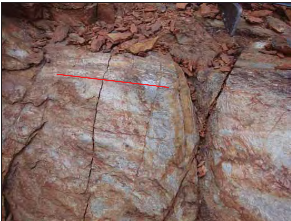
Figura 6.37. Dobras pós Dn vista em corte vertical, onde o S0 encontra-se no plano da foto, evidenciando, em vermelho, veios paralelos aos planos axiais das dobras pós-Dn. Foto visada para leste.
