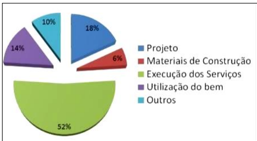
Figura 4 – Patologia na construção - Causa raiz
