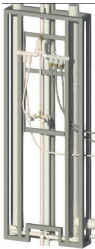
Figura 23 – Modelo de shaft hidráulico
