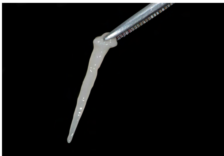
FIGURA 6 – Pino de cimento resinoso pronto e retirado do molde.
