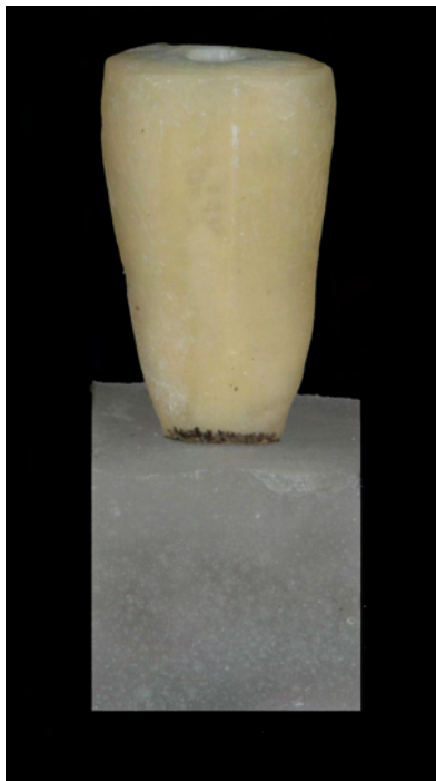
FIGURA 3 – Sp fixado na resina acrílica perpendicularmente ao solo.
