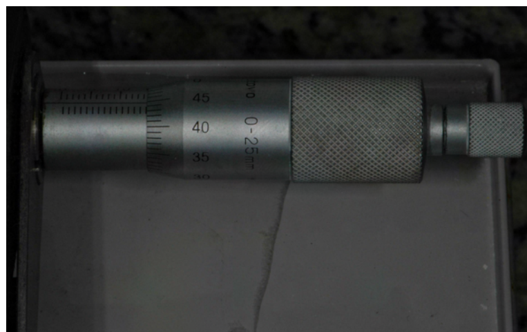
FIGURA 13 – Dispositivo nônio padronizador dos cortes da espessura dos Sp.
