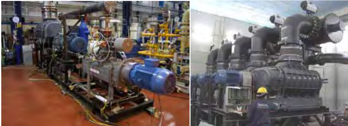
Figura 49: Foto da bomba seca (EDWARDS, 2012a).
