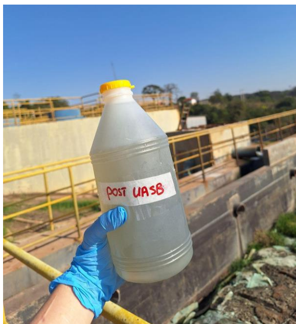
Figura 2. Frasco de plástico esterilizado com coleta de esgoto pós UASB. Fonte: Arquivo pessoal.
