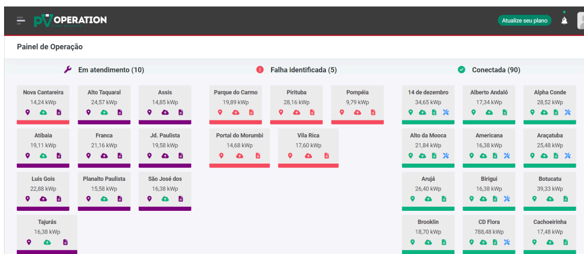
Figura 10 - Dashboard de monitoramento de UFV
