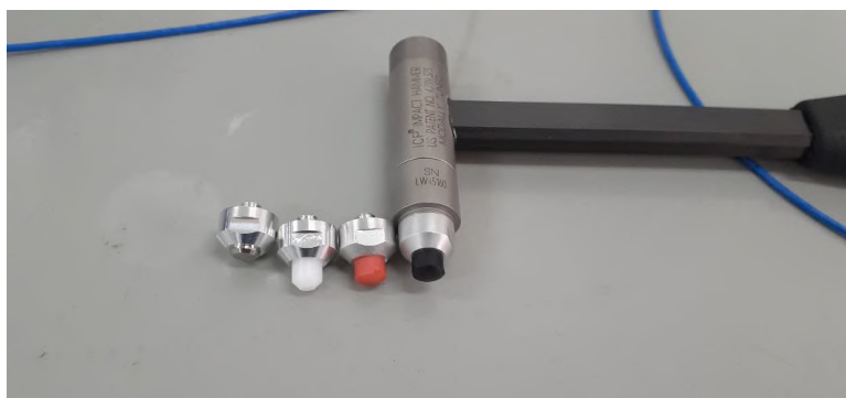
Figura 8 – Pontas utilizadas no martelo de impacto
