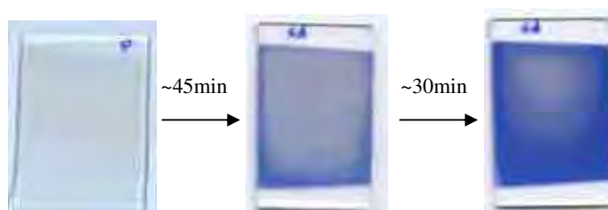
Figura 13: Fotos do filme NBW40 preparado que começou a sofrer modificações na coloração em relação ao tempo após sua preparação.
