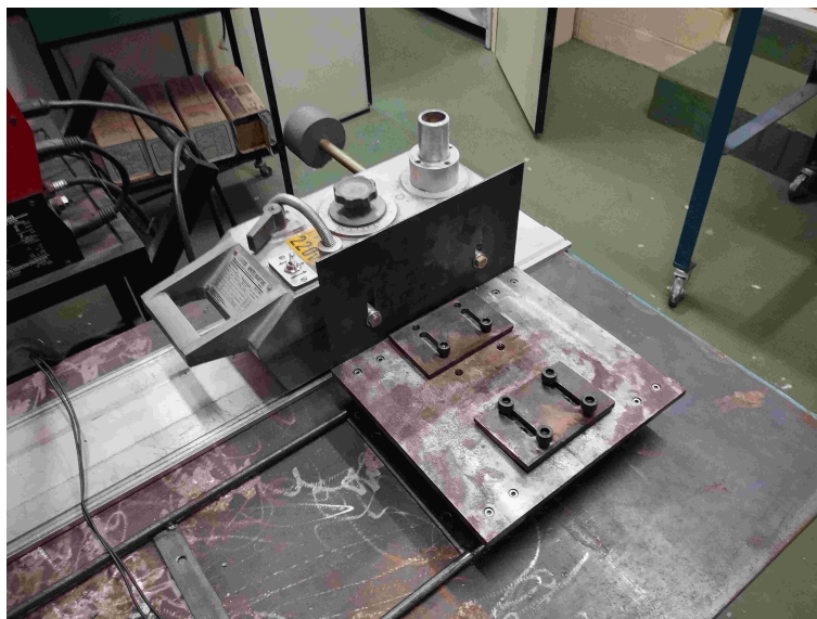
Figura 22 - Foto do carro portátil utilizado no tratamento GTAW
