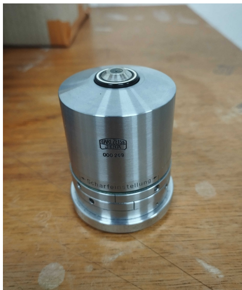
Figura 28 - Foto da lente utilizada com indentador de microdureza Vickers
