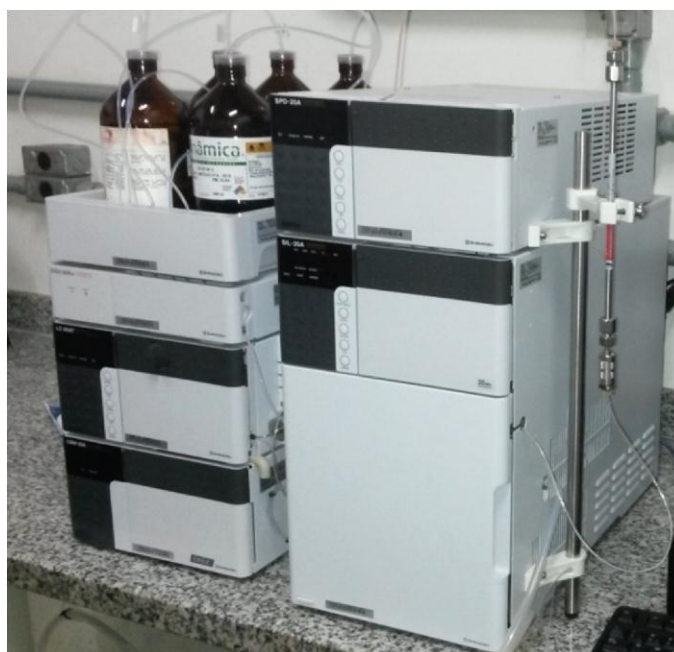
Figura 30 - Cromatógrafo empregado neste trabalho (CLAE)
