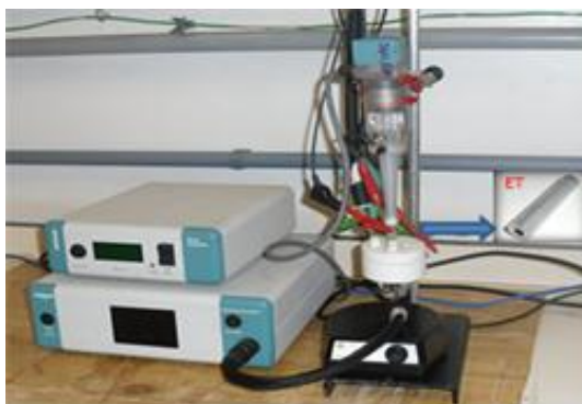
Figura 22 - Representação do sistema eletroquímico usando eletrodo de disco rotatório
