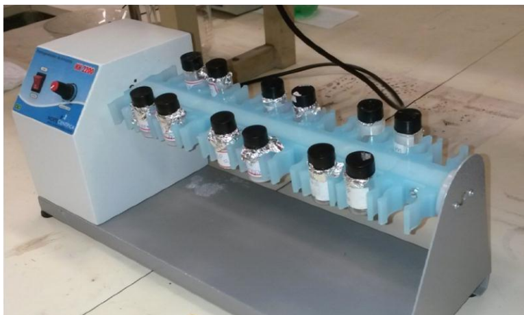
Figura 27 – Homogeneizador utilizado nos ensaios de religação de MIP/template
