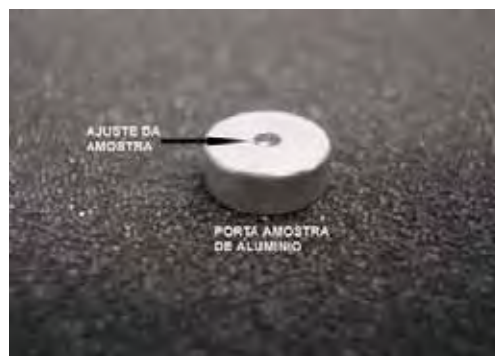
FIGURA 6 - Porta-amostra evidenciando o local onde a amostra foi colocada
