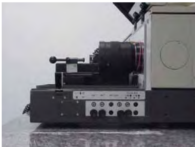
FIGURA 4 - Geometria de espalhamento e porta-amostra do FT-Raman Spectrometer RFS 100
