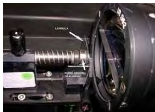
FIGURA 7 - Conjunto amostra/porta-amostra/lamínula no equipamento FT-Raman
