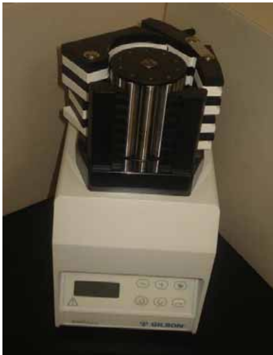
Figura 9 – Bomba peristáltica de oito canais utilizada no sistema FIA proposto.
