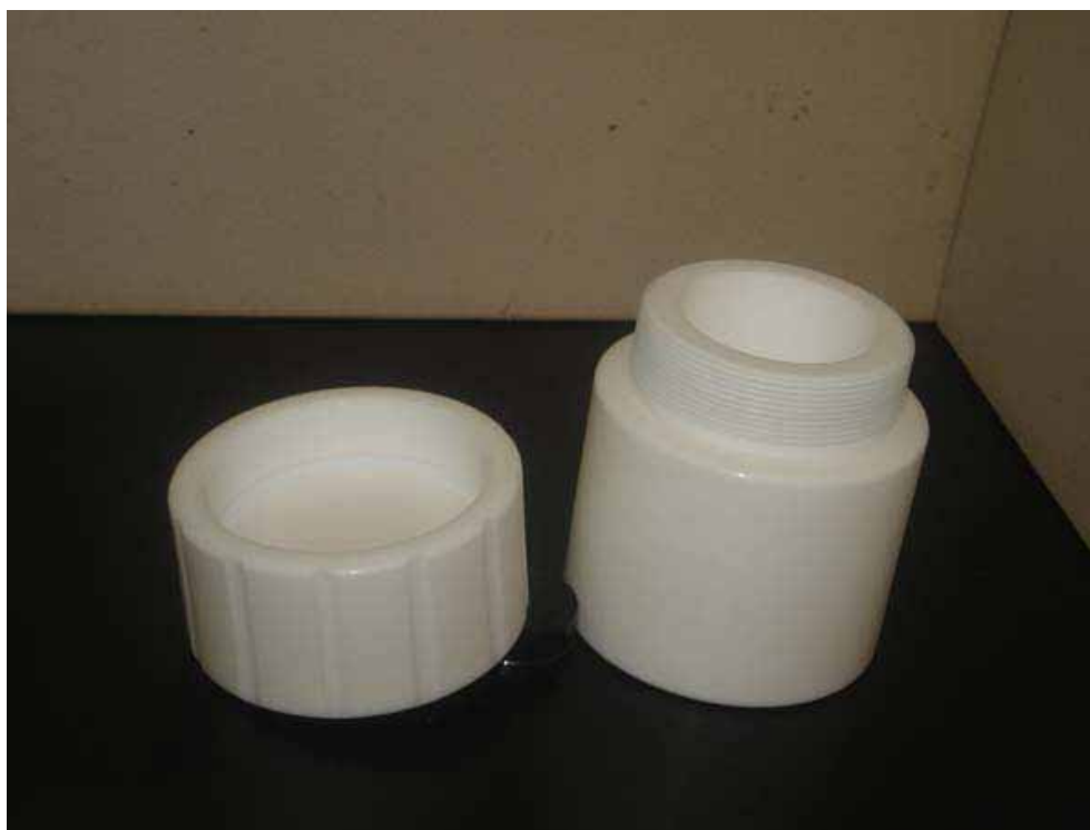
Figura 2 – Reator de teflon utilizado para realização da hidrólise do paracetamol em forno de microondas.
