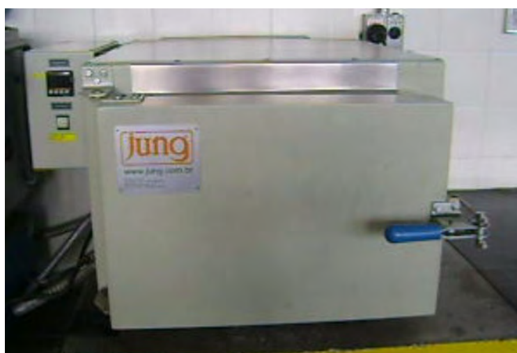
Figura 10 – Forno utilizado para precipitação (720°C / 8h) do INCONEL 718.
