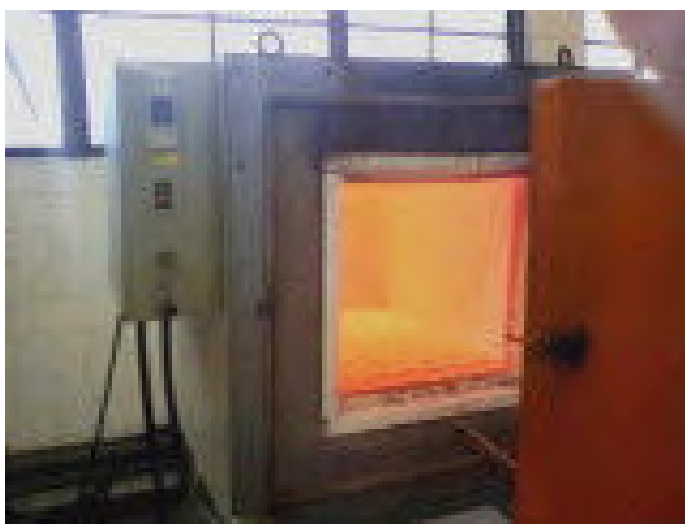
Figura 9 – Forno utilizado para solubilização (980°C / 3h) do INCONEL 718.
