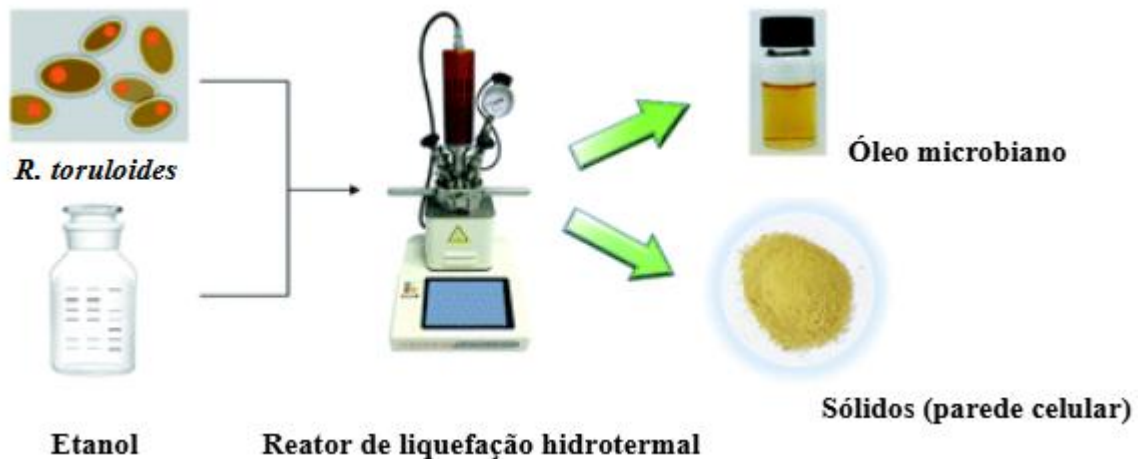
Figura 19. Representação do método de liquefação hidrotermal, com lise celular e extração de lipídios de leveduras oleaginosas.
