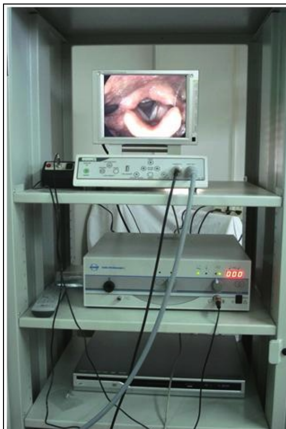
Figura 2 – Sistema conjugado de captura de imagem de videoendoscopia (video system type XE-30, Eco X – TFT/USB).
