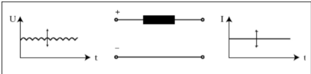
Figura 4 – Elo CC de corrente contínua ajustável.
