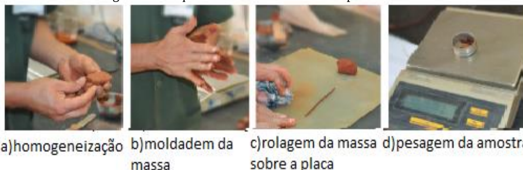
Figura 12 - Sequência do ensaio de limite de plasticidade
