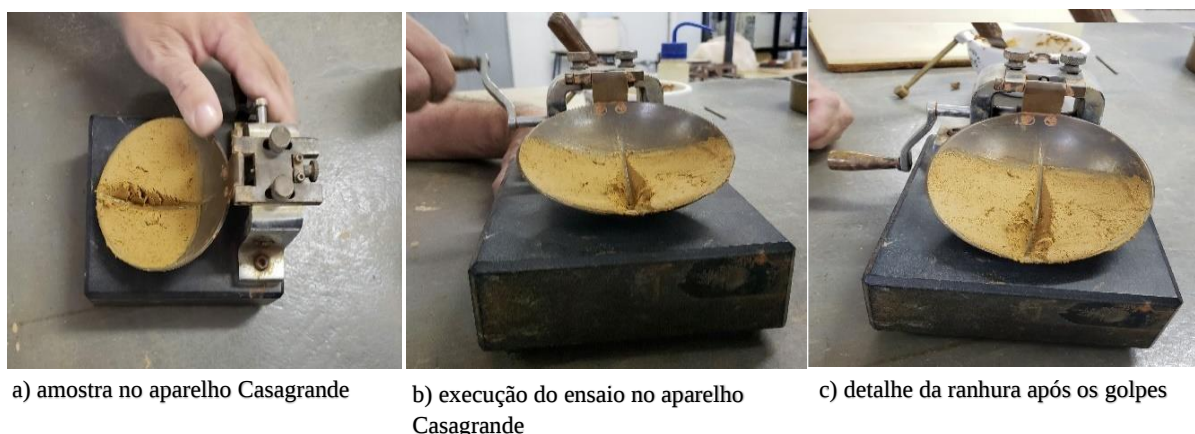
Figura 11 - Ensaio do limite de liquidez
