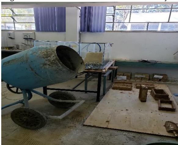
Figura 18 - Betoneira utilizada na mistura dos traços
