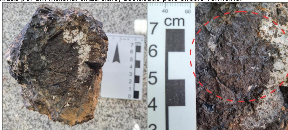
Figura 7: A esquerda pode ser observada a amostra O6. A direita se observa as microfaturas preenchidas por um material cinza claro, destacado pelo círculo vermelho.
