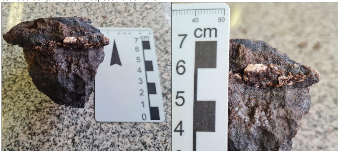
Figura 18: A esquerda pode ser observada a amostra O8. A direita se observa a pequena camada de quartzo com espessura de 2 a 3 mm.
