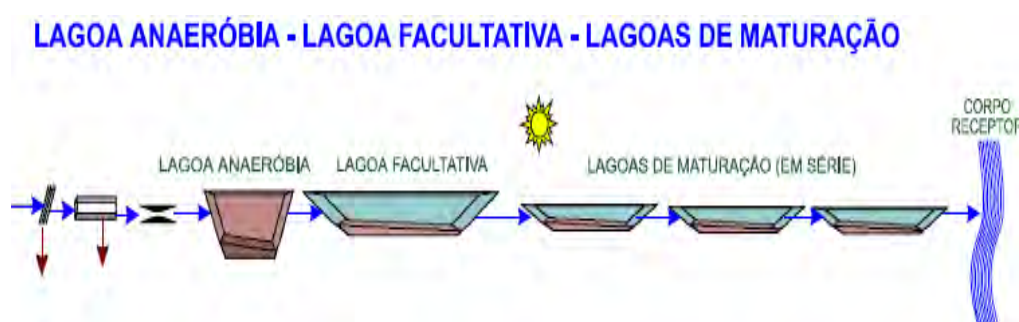
Figura 19: Fluxograma típico de um sistema de lagoas de estabilização seguidas por lagoas de maturação em série.
