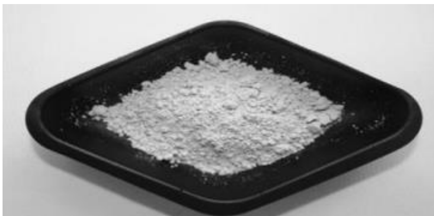
Figura 1: Cinzas de folha de bambu após o processo de calcinação
