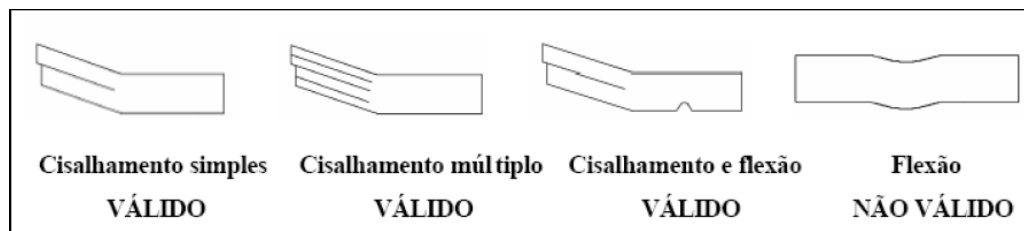
Figura 13 – Modos de falhas possíveis em amostras ensaiadas pelo método de cisalhamento interlaminar em três pontos ( short beam )
