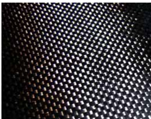
Figura 17 - Tecido de fibra de carbono utilizado no presente trabalho
