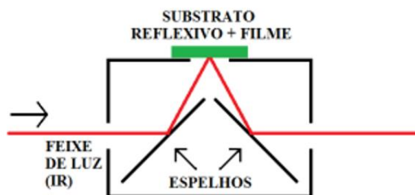
Figura 18 – Esquema para obtenção dos espectros pela técnica de IRRAS.
