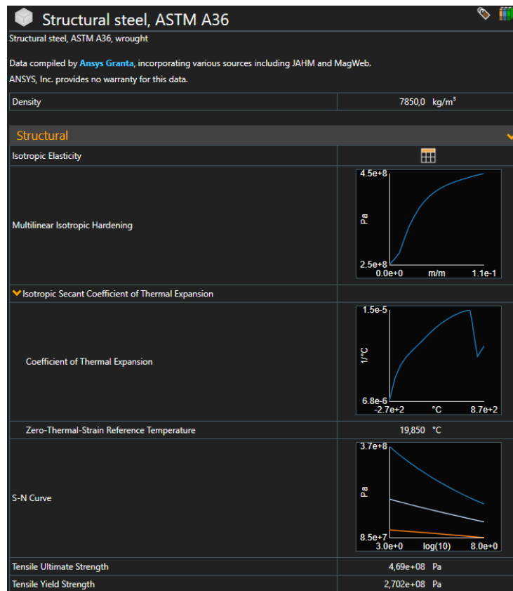
Figura 5 – Dados do material Aço ASTM A36
