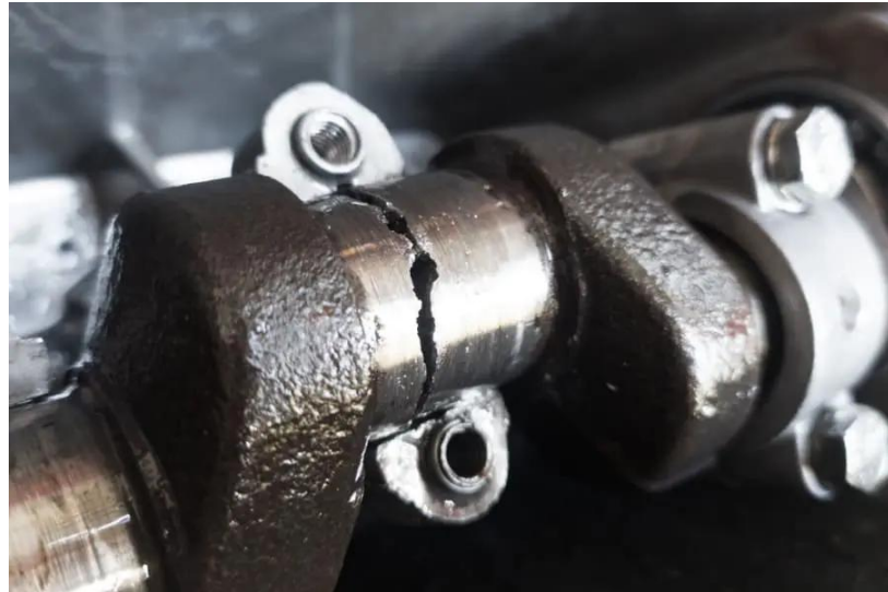
Figura 4 - Fratura de eixo por fadiga
