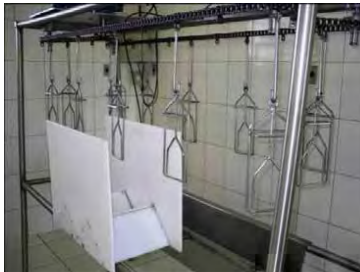
FIGURA 1 – Linha de pendura e cuba de imersão do abatedouro experimental da Faculdade de Medicina Veterinária de Araçatuba – FMVA/UNESP.
