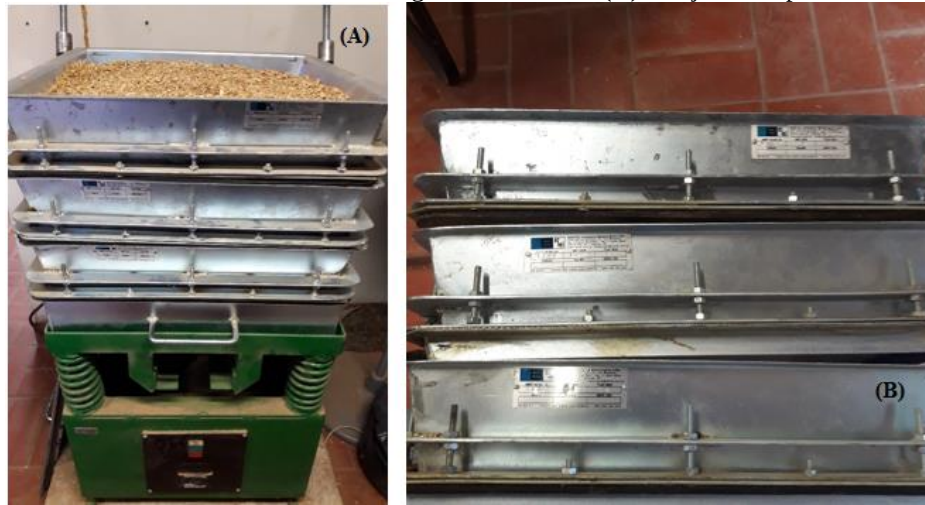
Figura 4.36: Peneira vibratórias montados em agitador mecânico (A), conjunto de peneiras vibratórias (B).
