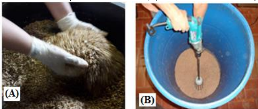
Figura 4.47: Mistura dos componentes manualmente (A) e Mistura mecânica dos componentes (B)
