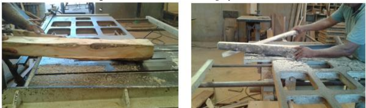
Figura 4.40: Retirada das toras em vigas para triturador
