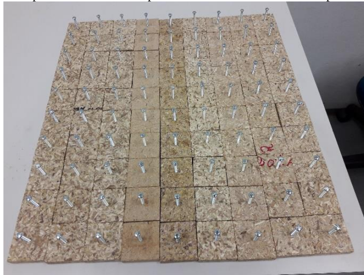
Figura 4.65: Corpos de prova 50\text{mm} \times 50\text{mm} para ensaios de arrancamento de parafuso (topo e superfície)
