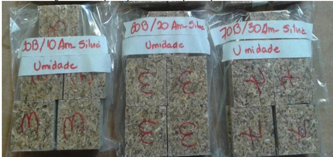
Figura 4.56: Corpos de prova medidos e pesados para ensaio de umidade.
