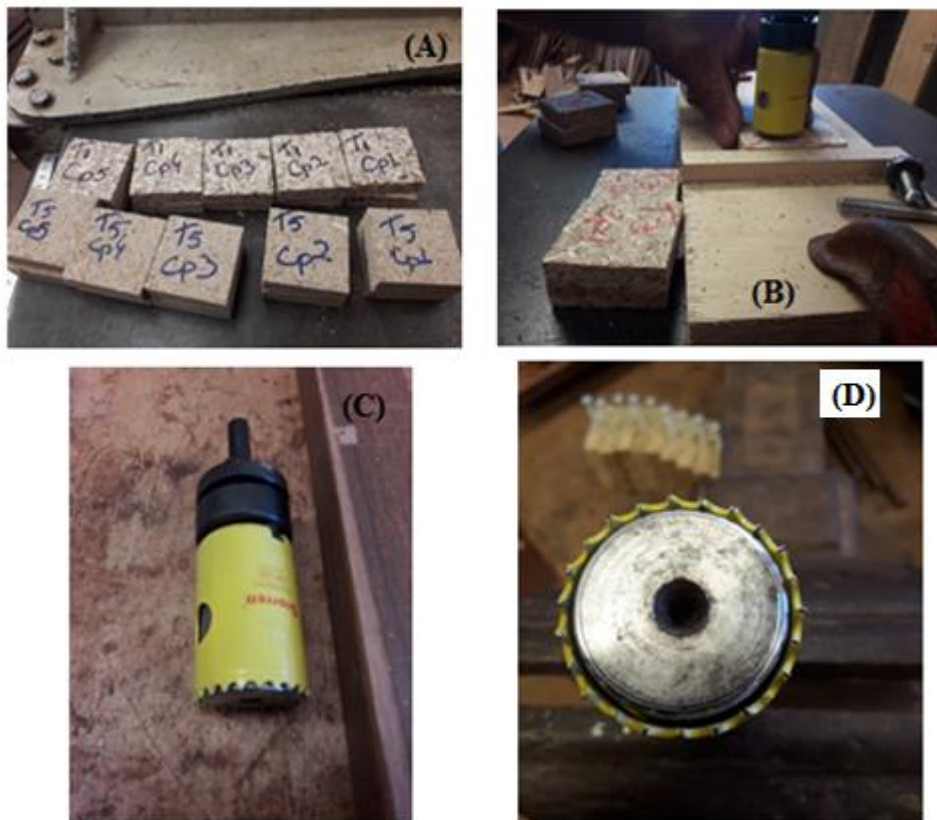
Figura 4.64: Corpos de prova 50mm x 50mm (A), Centro geométrico dos corpos de prova (B) serra copo e limitador com limitador de profundidade 1,0mm (C) e (D)
