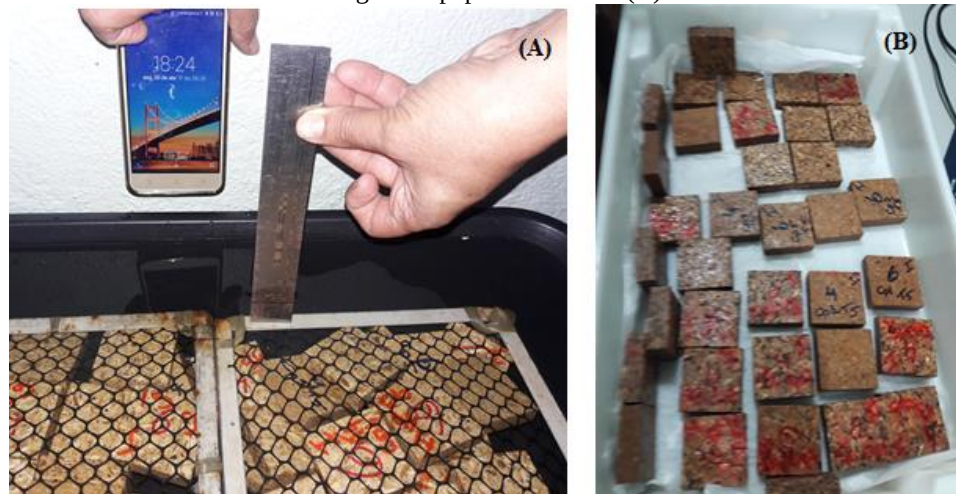
Figura 4.57: Corpos de prova submersos em água para determinar a absorção de água (A), retirada do excesso de água em papel absorvente (B)
