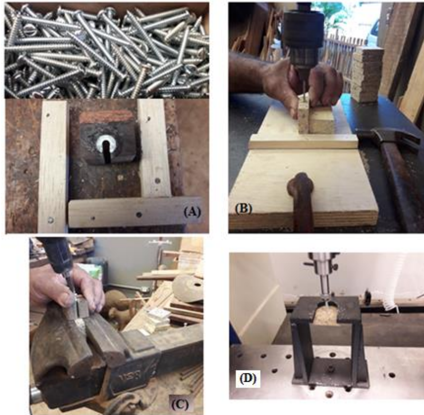
Figura 4.66: Suportes para garantir centralização e profundidade de furação dos corpos de prova (A), furação e rosca do parafuso(B) e (C), esquema para ensaio de arranque de superfície (D)
