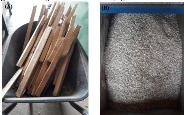
Figura 4.42: Vigas de madeira Teca (A), material triturado (B)
