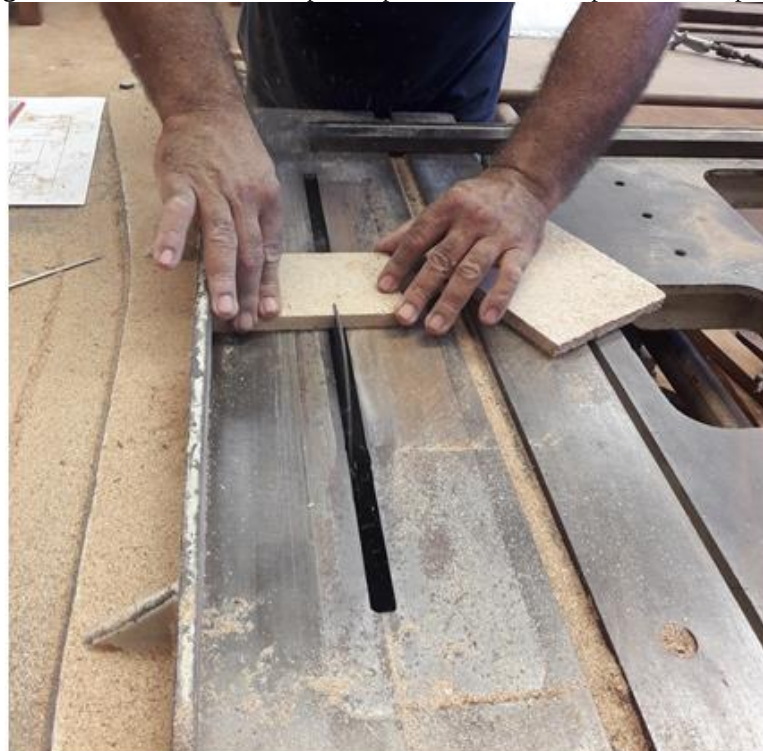
Figura 4. 53: Retirada dos corpos de prova conforme mapeamento do painel
