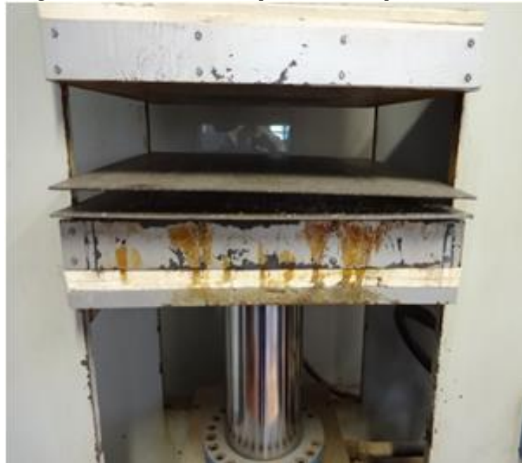
Figura 4.50: Colchão entre chapas metálica em prensa hidráulica
