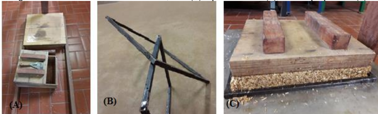
Figura 4.48: Caixa formadora 380 x 320 x 12,7 mm (A) e quadro metálico (B), Colchão pré prensado (C)
