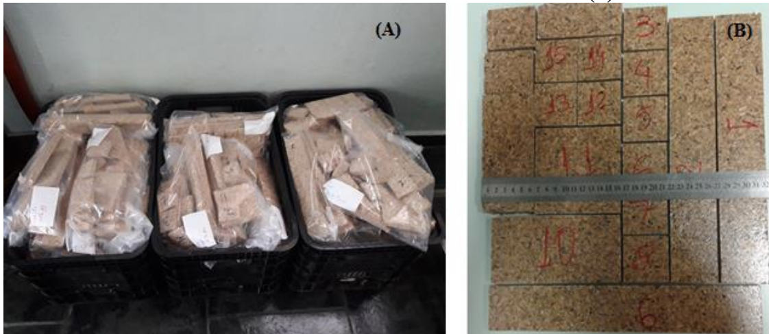
Figura 4.52: Painéis cortados em posição de retirada dos corpos de prova (A), modelo do plano do desenvolvimento de corte conforme norma NBR 14810-2 (B)
