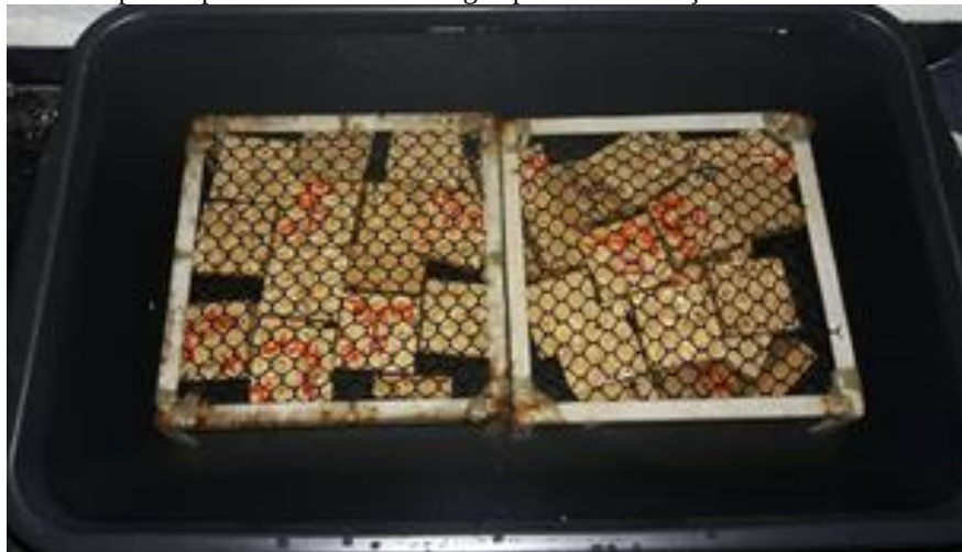
Figura 4.58: Corpos de prova submersos em água para determinação do inchamento em espessura
