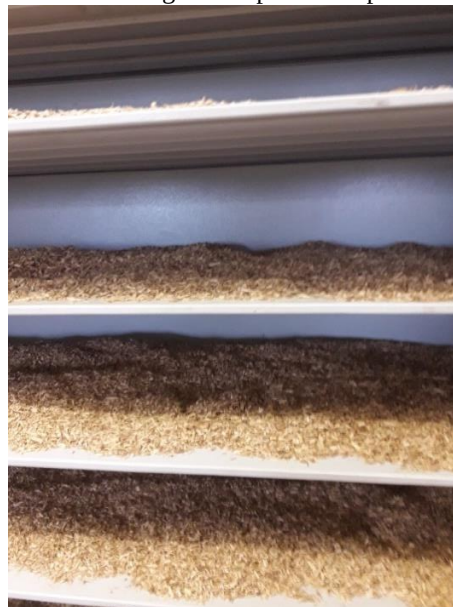
Figura 4.39: Estufa Solab – secagem das partículas para formação dos colchões
