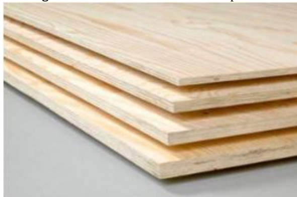
Figura 3.22: Painéis de madeira compensada
