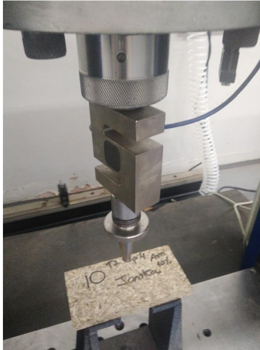
Figura 4.67: Ponto de carga e penetração da esfera para determinação de dureza Janka
