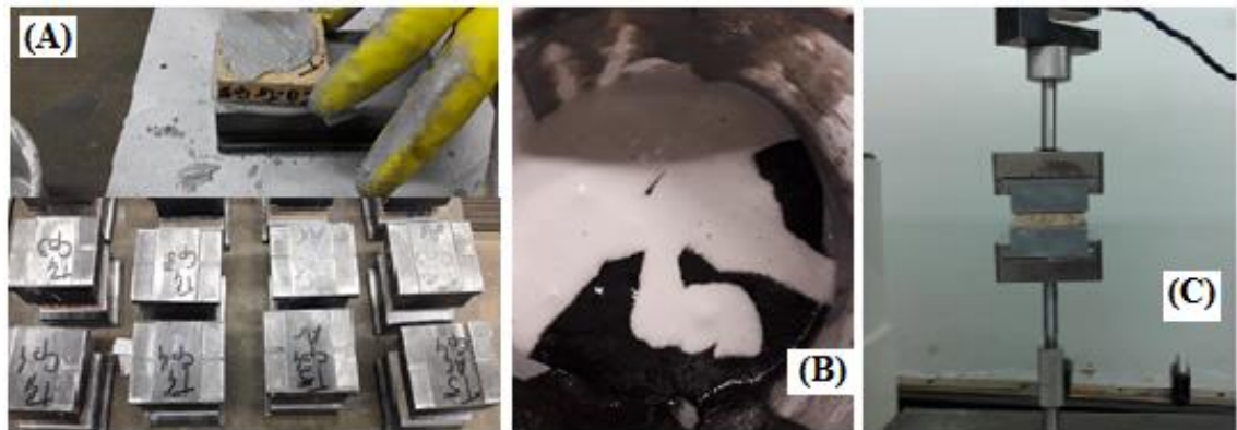
Figura 4.63: Corpos de prova colados aos suportes (B) Componentes A e B do adesivo (C) Ensaio de tração perpendicular (D)
