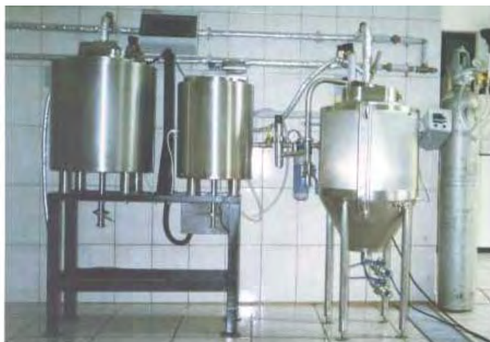
Figura 4: Planta piloto para produção de refrigerantes, à esquerda tanque de preparo e resfriamento do xarope composto, no centro tanque de produção de xarope simples e à direita tanque de carbonatação e cilindro de CO 2 .
