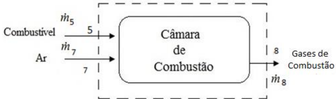
Figura 25. Volume de controle na câmara de combustão.
