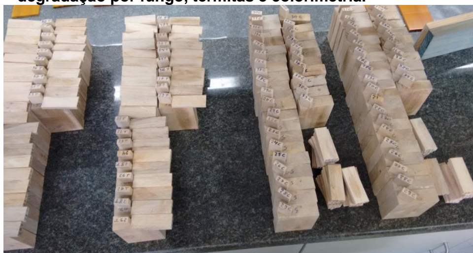
Figura 14 – Amostras destinadas à preservação química em autoclave experimental, o conjunto de amostras é destinada a ensaios de degradação por fungo, térmitas e colorimetria.
