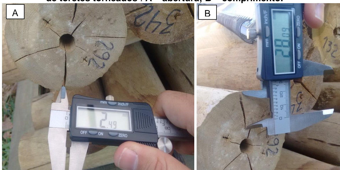
Figura 5 – Mensuração das aberturas e comprimentos das rachaduras de topo de toretes torneados : A – abertura; B – comprimento.
