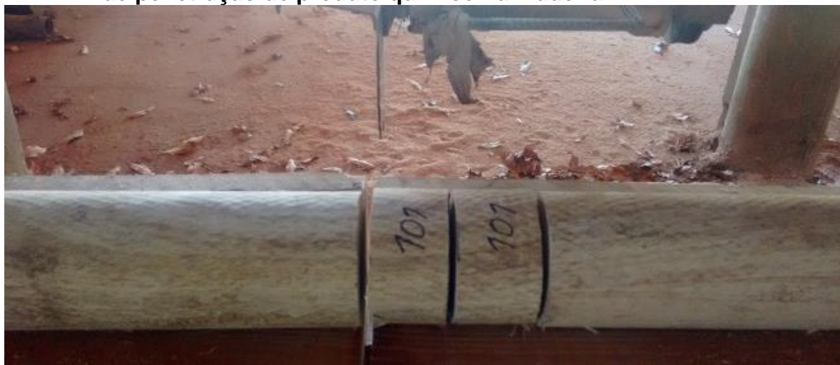
Figura 10 – Retiradas dos discos das amostras para que seja realizado o teste de penetração de produto químico na madeira.
