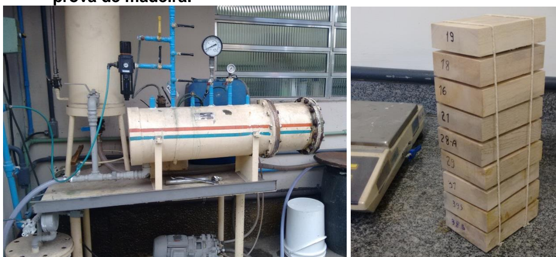
Figura 13 – Autoclave em escala experimental para preservação de corpos de prova de madeira.
