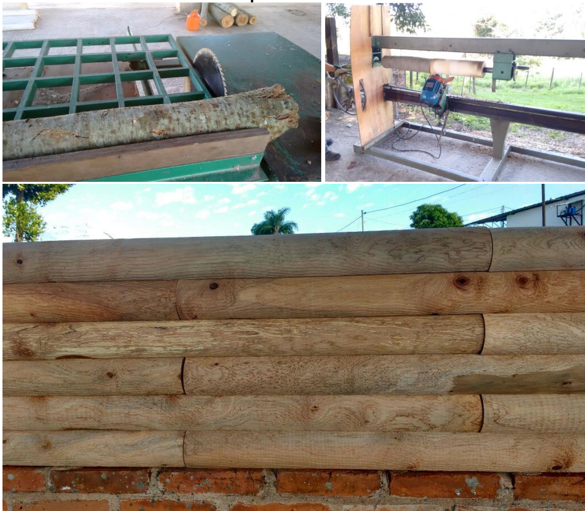
Figura 6 – Processo de torneamento de madeira para utilização em construção civil, passando pela apara da ponta para padronização do comprimento, tornearia e a representação do produto acabado montado em forma de parede.
