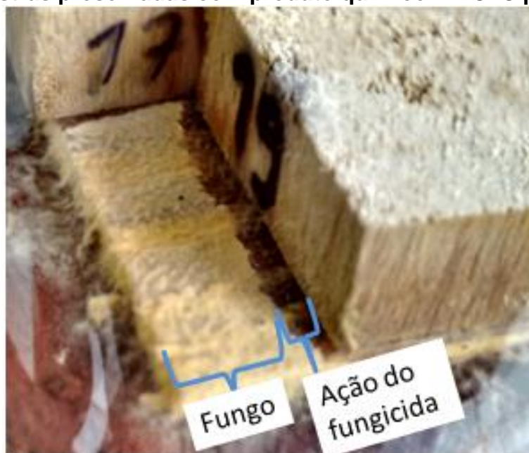
Figura 22 – Caracterização da reação de isolamento do fungo causado por amostras preservadas com produto químico IPBC+Cipermetrina.
