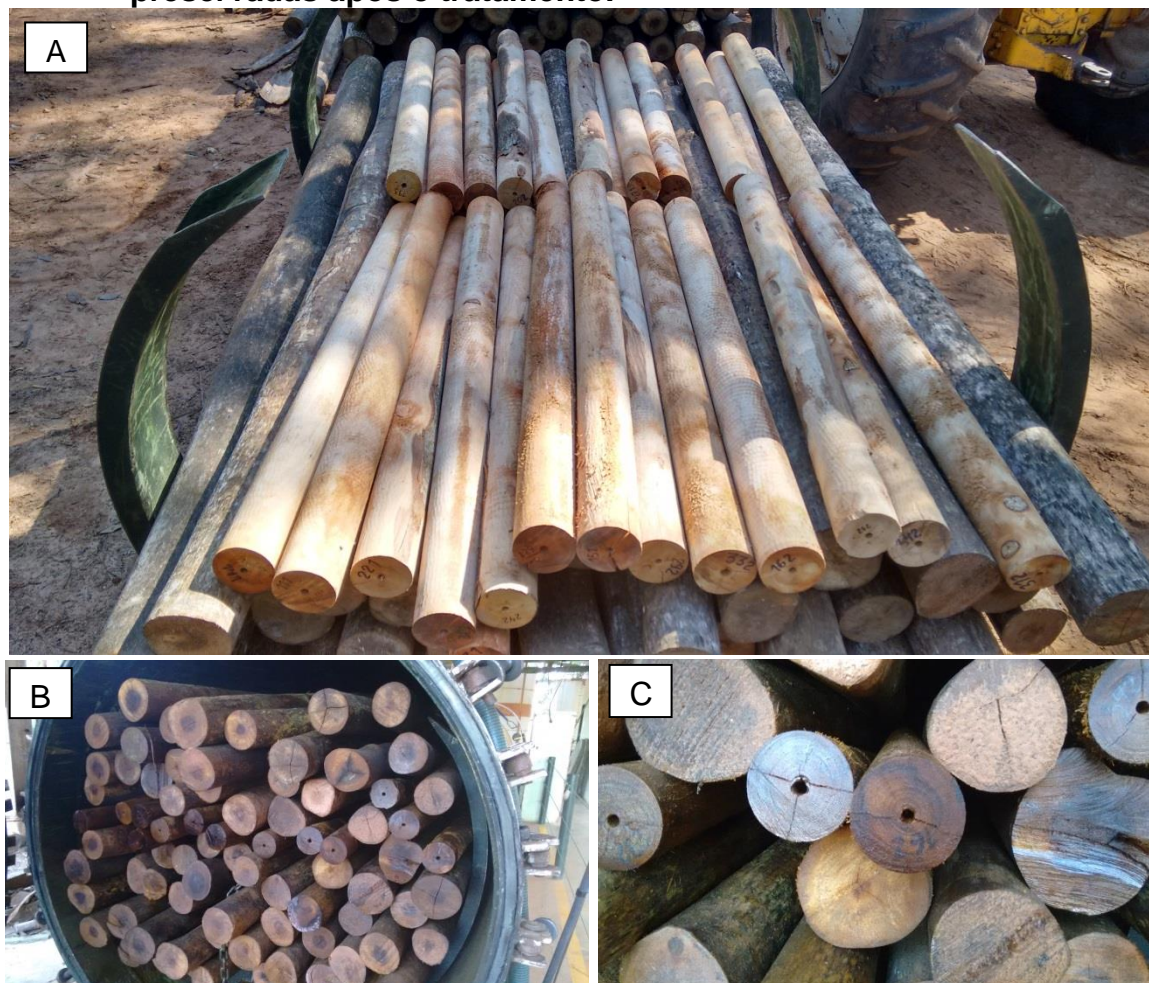
Figura 9 – Madeira torneada em processo de preservação industrial: A – Peças dispostas no carro porta-toras antes do tratamento; B e C– Peças já preservadas após o tratamento.
