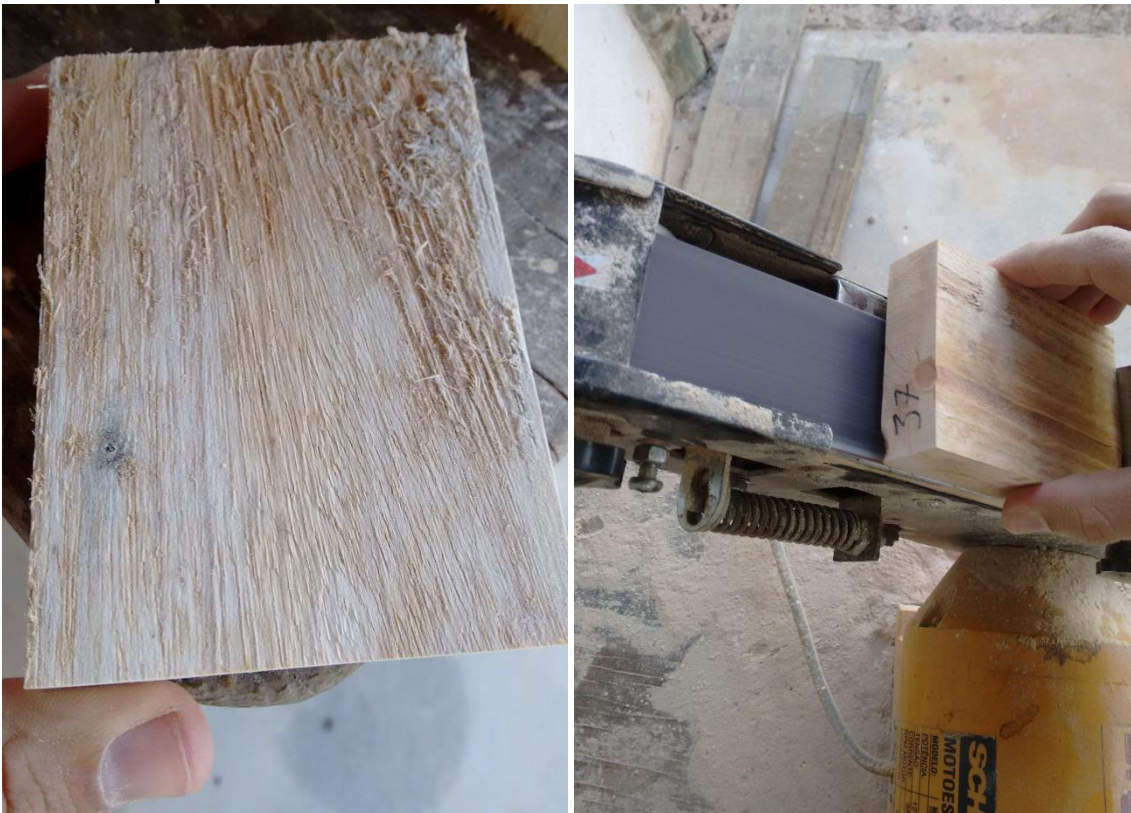
Figura 17 – Amostras preparadas para ensaio de cor na madeira, demonstrando a peça bruta inacabada com a rugosidade natural e o processo de lixamento.
