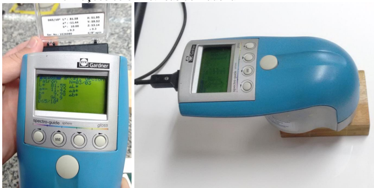
Figura 18 – Calibração e uso do Espectrofotômetro Portátil para coleta de informações colorimétricas de madeira.
