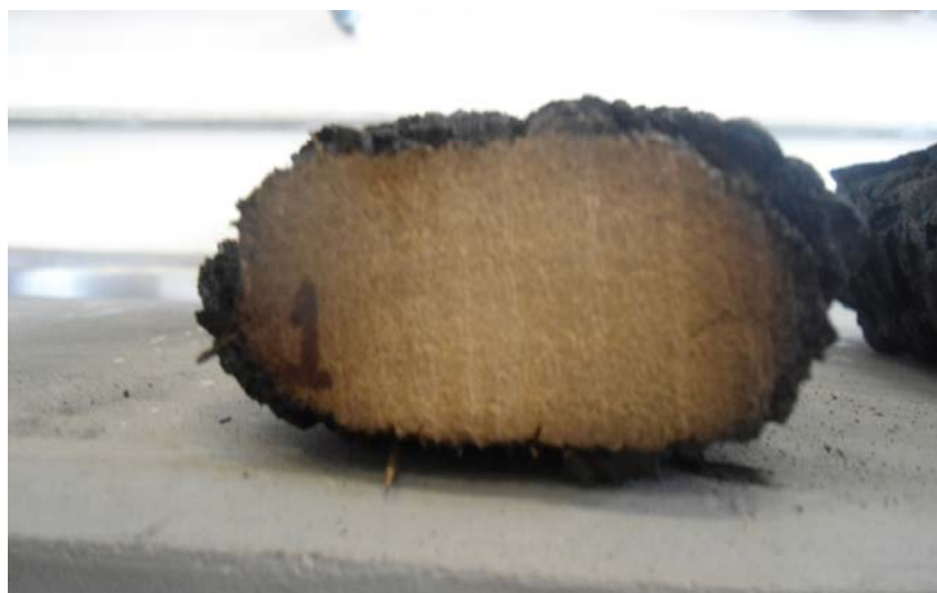
Figura 22 - Peça seccionada ao meio para verificação da seção carbonizada e a seção de madeira efetiva.
