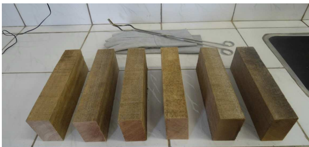
Figura 20 - Corpos de prova de dimensões 5 x 10 x 30 cm.
