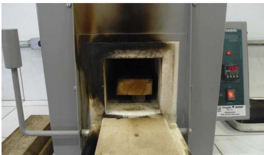
Figura 21 - Corpo de prova dentro da Mufla.
