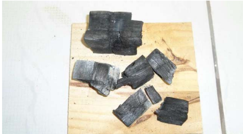
Figura 18 - Corpos de prova do teste incinerados a 1000°C por 2 h e 16 min..
