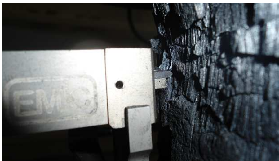
Figura 28 - Posicionamento das "garras" do extensômetro.
