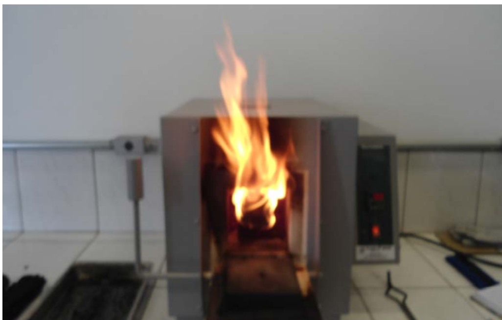
Figura 24 - Corpo de prova em chamas após abertura da Mufla aos 600°C, produzindo o efeito “Backdraft”.
