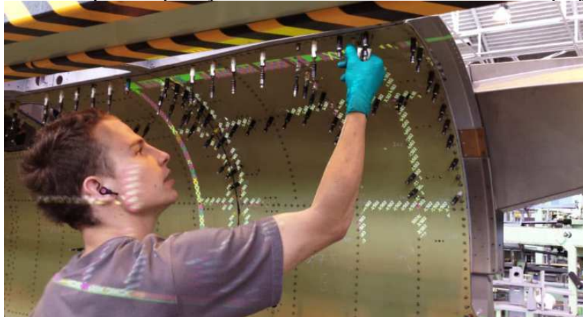
Figura 6 - Exemplo de aplicação de realidade aumentada utilizando projetores.
