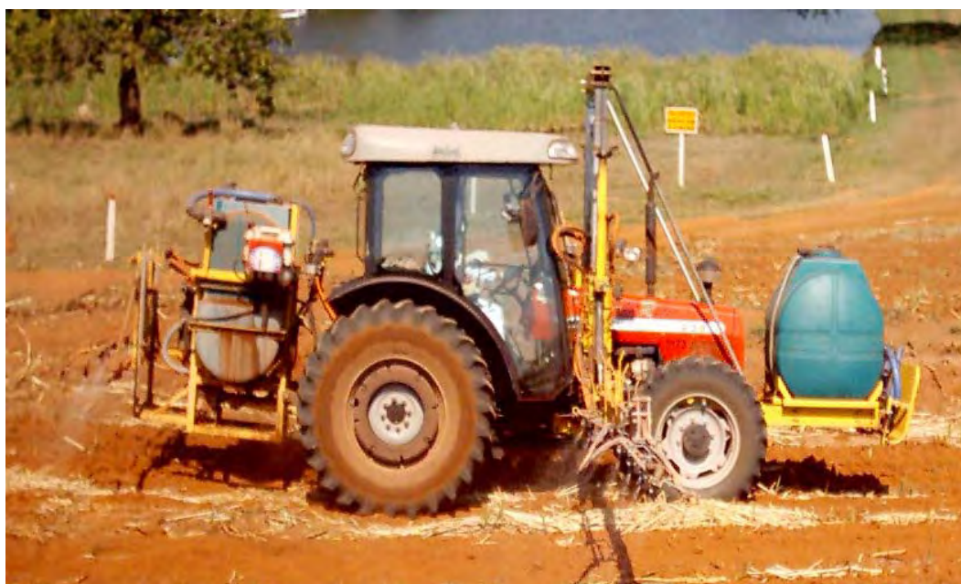
Figura 2. Trator MF 275 cabinado, equipado com pulverizador de Barra Central, Herbiplus.
