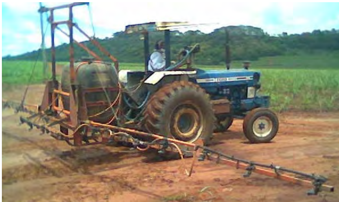
Figura 4. Trator Ford 6630 sem cabina, equipado com pulverizador de Barra Traseira, modelo Condor 600.
