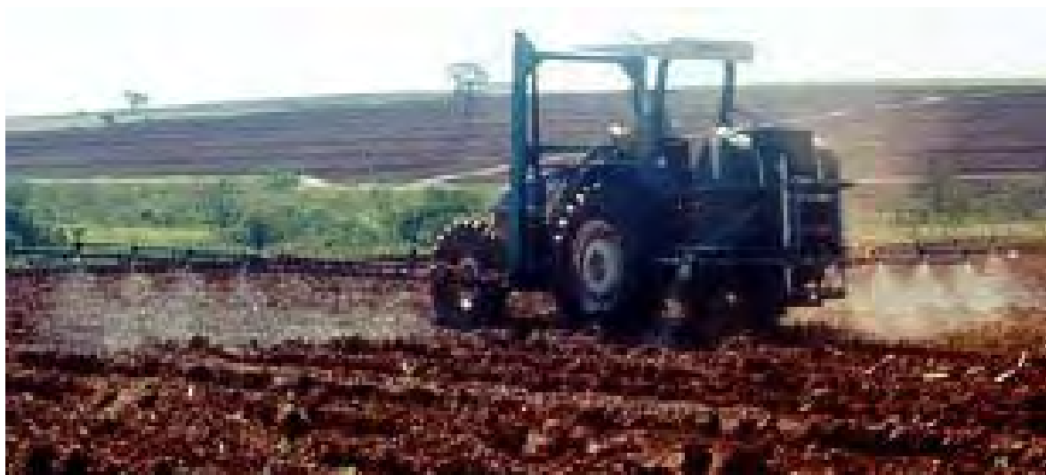
Figura 1. Pulverizador modelo Herbiplus com barra central montado em trator sem cabina.
