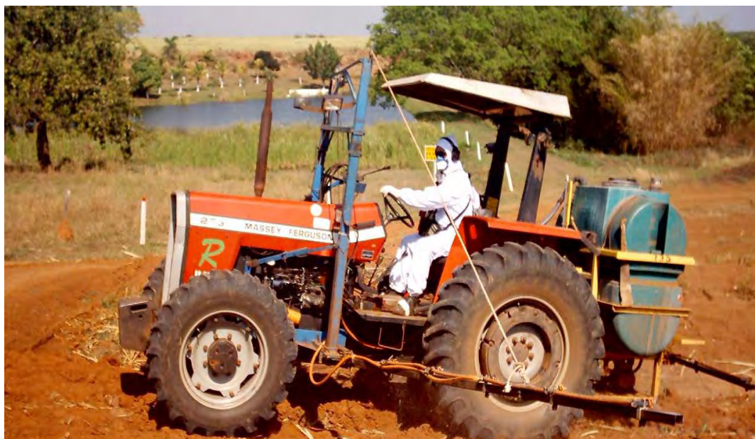
Figura 3. Trator MF 275 sem cabina, equipado com pulverizador de Barra Central, Herbiplus.
