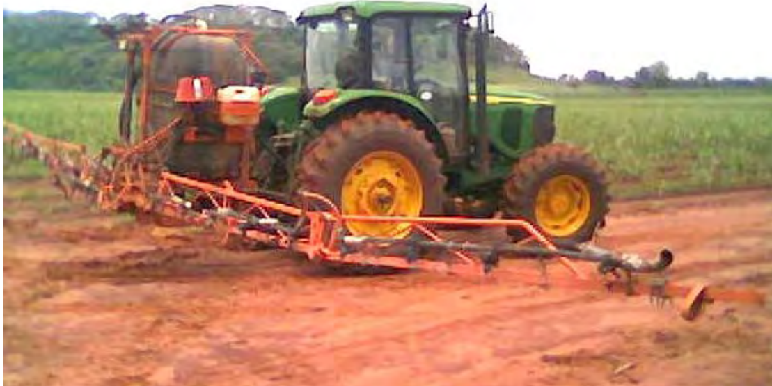
Figura 5. Trator John Deere com cabina original, equipado com pulverizador de Barra Traseira, modelo Falcon 800.
